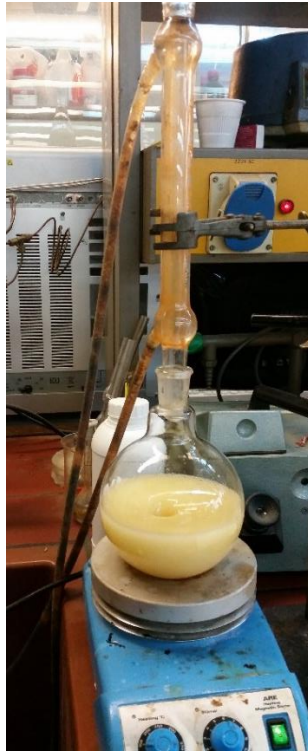
Εικόνα 6-5: Διάταξη αντίδρασης εστεροποίησης με καταλύτη θειικού οξέος.
