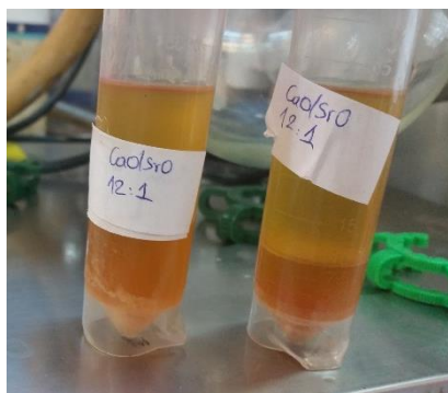
Εικόνα 6-30: Η άνω φάση στην αριστερή εικόνα είναι η περίσσεια αιθανόλης που δεν αντέδρασε, η μεσαία φάση είναι η εστερική, δηλαδή το βιοντήζελ και η κατώτερη φάση είναι η γλυκερινική, δηλαδή το παραπροϊόν της μετεστεροποίησης. Στη δεξιά εικόνα δεν είναι εμφανής η περίσσεια αιθανόλης.
