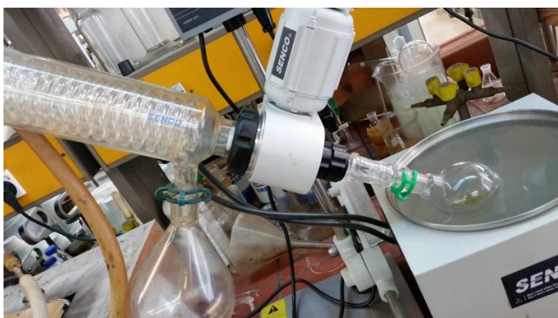
Εικόνα 6-7: Εργαστηριακή διάταξη περιστροφικού αναδευτήρα υπό κενό.
