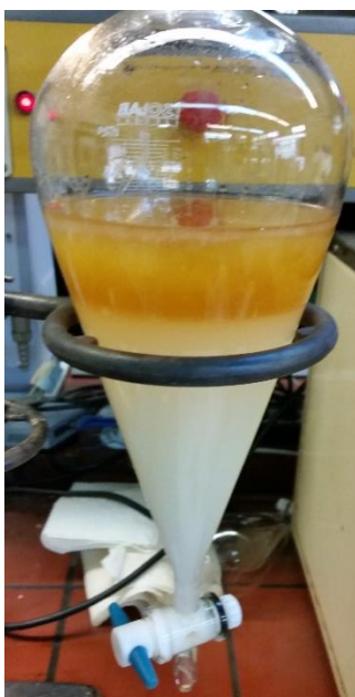
Εικόνα 6-6: Θόλωμα στη φάση του νερού λόγω εξουδετέρωσης του όξινου ομογενούς καταλύτη της εστεροποίησης και σχηματισμό δυσδιάλυτου άλατος.
