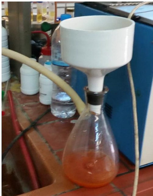
Εικόνα 6-2: Διάταξη διήθησης υπό κενό των τηγανελαίων.
