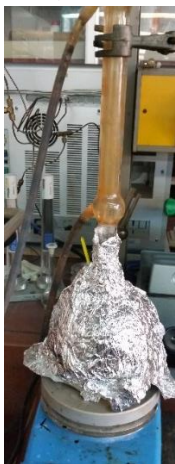
Εικόνα 6-14: Μετεστεροποίηση σησαμελαίου με 9:1 αναλογία αιθανόλης:ελαίου, 0.8 %wt NaOH και για χρόνο 3 ωρών.
