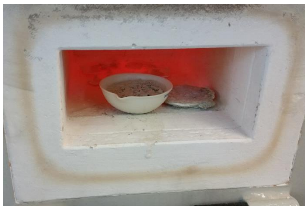
Εικόνα 6-19: Πύρωση του μίγματος νιτρικών αλάτων στους 800^{\circ}\text{C} και σχηματισμός οξειδίων τα οποία προσκολλώνται στα τοιχώματα της κάψας.
