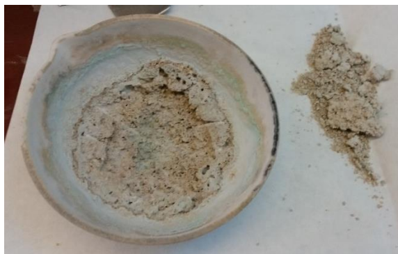
Εικόνα 6-20: Απόσπαση καταλύτη \text{CaO/SrO} την κάψα.
