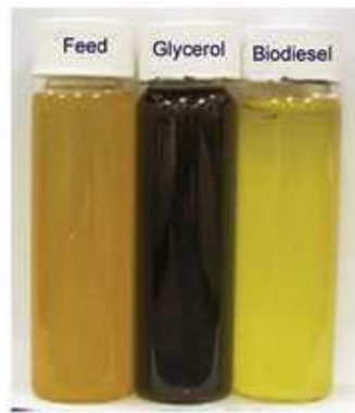
Εικόνα 5-3: Αποτελέσματα διαχωρισμού μιας τροφοδοσίας μεθυλεστέρων/γλυκερίνης/μεθανόλης/ ομογενούς καταλύτη (Feed) στην εστερική φάση (Biodiesel) που περιέχει βιοντήζελ και μεθανόλη και στην γλυκερινική φάση (Glycerol) που περιέχει την γλυκερίνη, τον καταλύτη και μια μικρή ποσότητα μεθανόλης.
