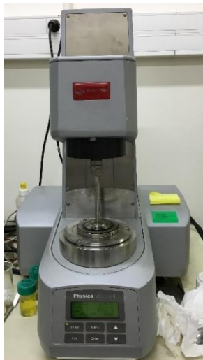
Εικόνα 6-27: Ρόμετρο 'Physica MCR 301 Anton Paar'.
