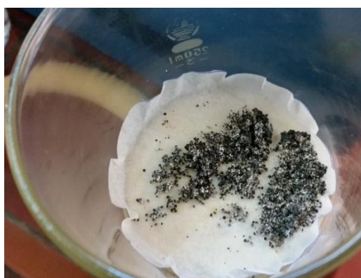
Εικόνα 6-32: Το άσπρο χρώμα στην επιφάνεια του Amberlyst αποδεικνύει ότι στην εστερική φάση υπάρχει μια ποσότητα του καταλύτη που διαλυτοποιείται.
