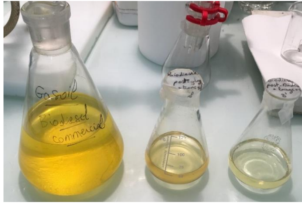
Εικόνα 6-24: Αριστερό δείγμα: Νητζέλ με 7% βιονητζέλ στη Γαλλία. Μεσαίο δείγμα: Προϊόν μετεστεροποίησης με αιθανόλη και καταλύτη από πυρωμένο κέλυφος αυγών. Δεξί δείγμα: Προϊόν μετεστεροποίησης με μεθανόλη και καταλύτη ΚΟΗ.
