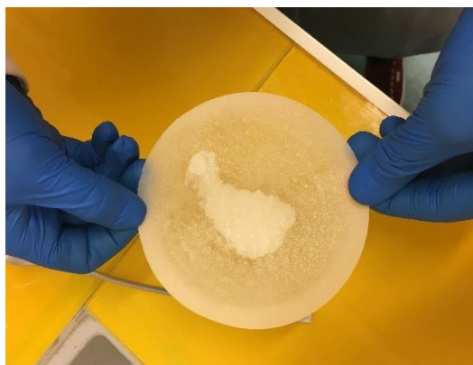
Εικόνα 6-22: Συλλογή σαπώνων καταλύτη-θειϊκού οξέος στο διηθητικό χαρτί.
