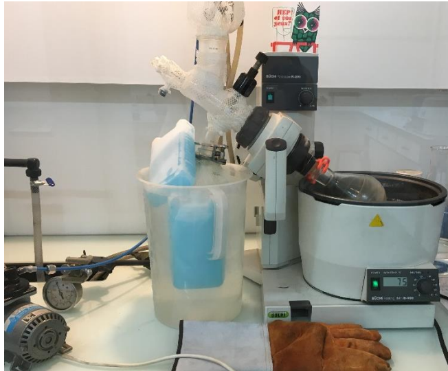
Εικόνα 6-23: Διάταξη περιστροφικού εξατμιστήρα υπό κενό στην Ecole Centrale de Paris.
