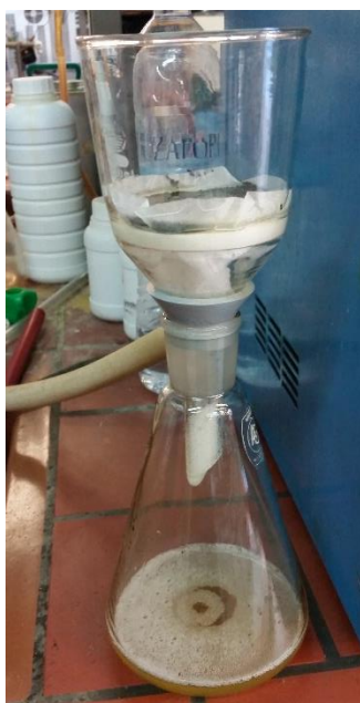
Εικόνα 6-31: Διάταξη διήθησης υπό κενό για απομάκρυνση διαλυτού στην εστερική φάση καταλύτη.
