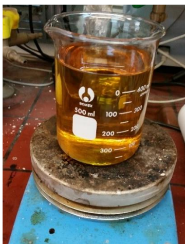
Εικόνα 6-4: Θέρμανση τηγανελαιίου από το οποίο έχουν απομακρυνθεί τα στερεά κατάλοιπα.
