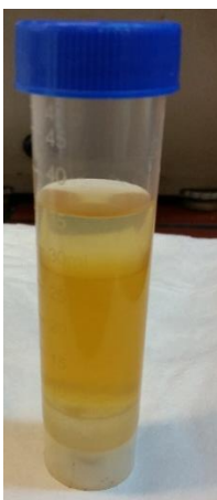
Εικόνα 6-30: Η άνω φάση στην αριστερή εικόνα είναι η περίσσεια αιθανόλης που δεν αντέδρασε, η μεσαία φάση είναι η εστερική, δηλαδή το βιοντήζελ και η κατώτερη φάση είναι η γλυκερινική, δηλαδή το παραπροϊόν της μετεστεροποίησης. Στη δεξιά εικόνα δεν είναι εμφανής η περίσσεια αιθανόλης.
