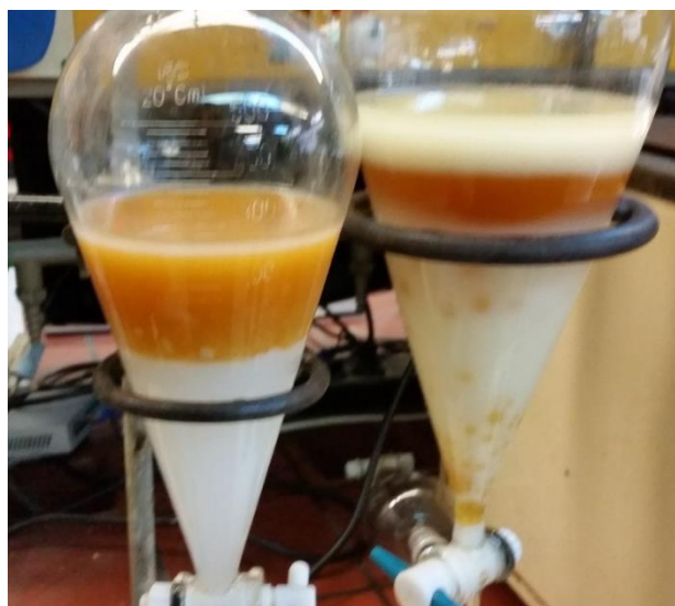
Εικόνα 6-8: Σχηματισμός γαλακτωμάτων στο δείγμα της δεξιάς χοάνης σε αντίθεση με το σχηματισμό αλάτων-προϊόντων εξουδετέρωσης του θειικού οξέος.
