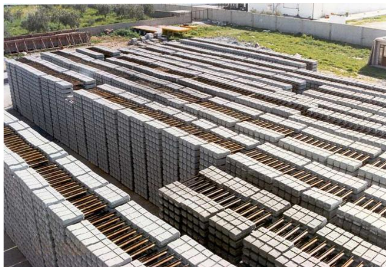
Εικόνα 46: Προκατασκευή στρωτήρων για το Αττικό ΜΕΤΡΟ.
