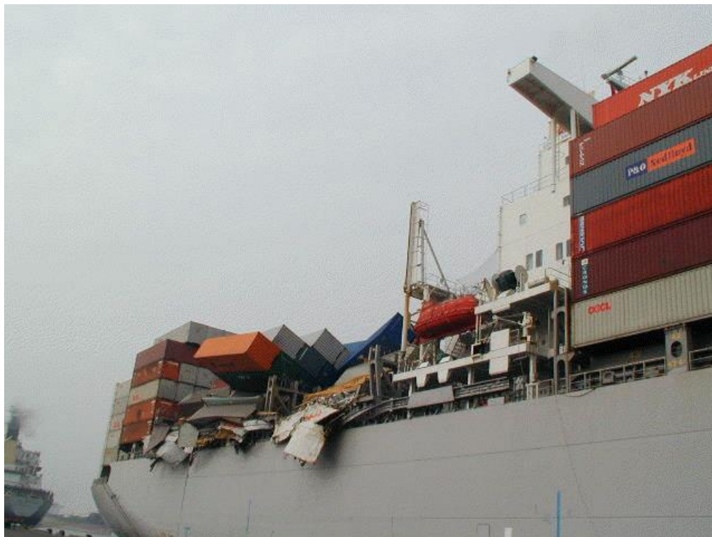
8. Φωτογραφίες του M/V OOCL AMERICA μετά από κακοκαιρία και απώλεια εμπορευματοκιβωτίων στη θάλασσα, 2000.
