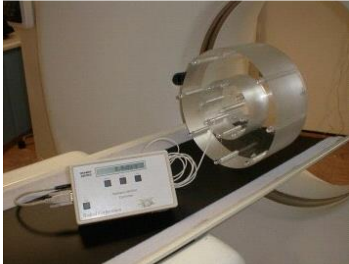
Εικόνα 10 : Ο εξοπλισμός που χρησιμοποιείται για τον υπολογισμό του CTDI_{100} , το integration ηλεκτρόμετρο, ο θάλαμος ιονισμού μήκους 100 εκατοστών και τα ομοιώματα 16 και 32 εκατοστών [10]
