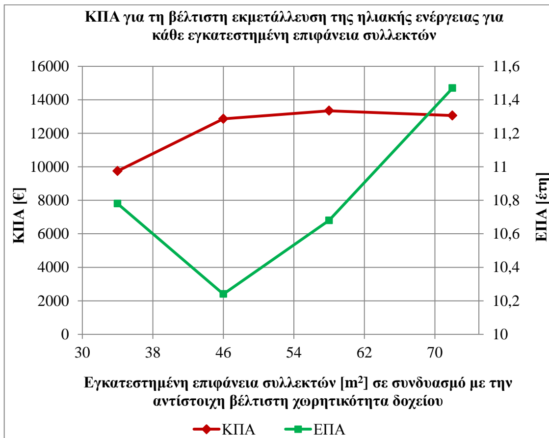
Σχήμα 4.3-6 : ΚΠΑ και ΕΠΙΑ για το συνδυασμό εγκατεστημένης επιφάνειας συλλεκτών και χωρητικότητας δοχείου αποθήκευσης που εξασφαλίζουν τη βέλτιστη εκμετάλλευση της ηλιακής ενέργειας
