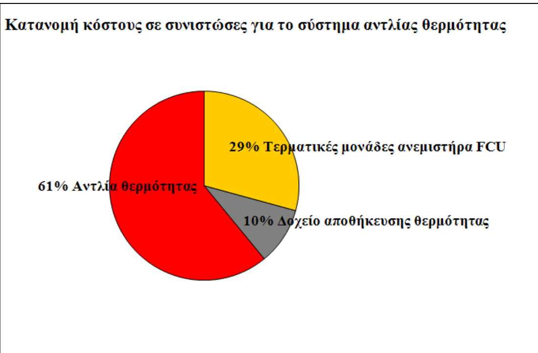
Σχήμα 5.3-1 : Κατανομή κόστους επένδυσης σε επιμέρους συνιστώσες για το σύστημα με αντλία θερμότητας
