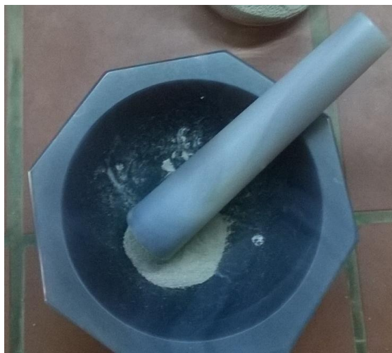
Εικόνα 4-3 Λειοτριβήση της ρητίνης σε μέγεθος <math><45\mu\text{m}</math>.
