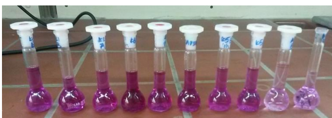
Εικόνα 4-6 Απεικόνιση δειγμάτων προς μέτρηση εξασθενούς χρωμίου, μεταφορά τους σε κυψελίδες και μέτρηση στο φασματοφωτόμετρο UV-Vis σε μήκος κύματος 540nm.
