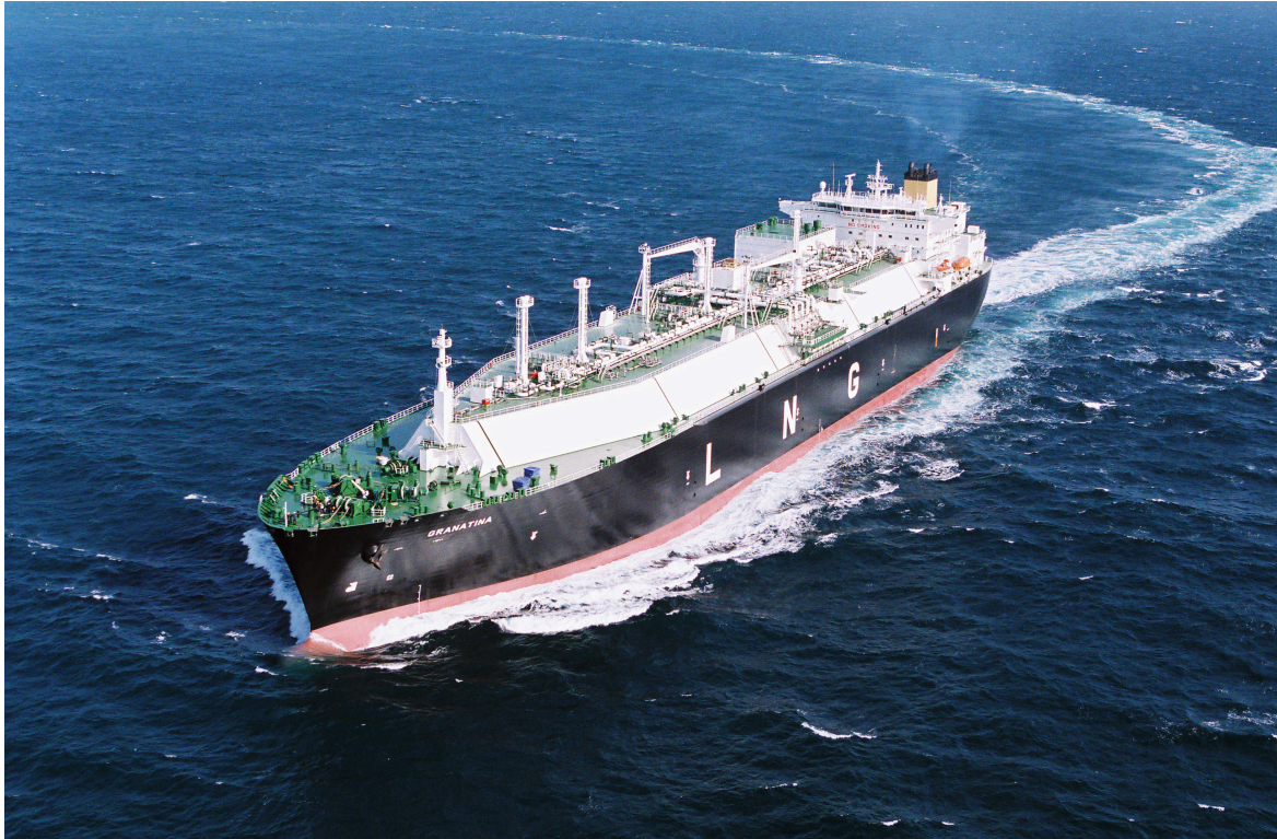
Εικόνα 1.2: Πλοίο μεταφοράς LNG με μεμβρανοειδείς δεξαμενές. (© Japan Marine United Corporation)
