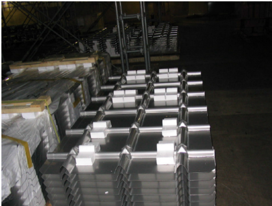
Εικόνα 5.2: Ελάσματα για την κατασκευή primary membrane. (♥ SAMSUNG Heavy Industries )
