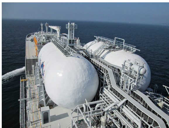
Εικόνα 2.4: Type C LNG Fuel Tank. (♥ Wärtsilä )
