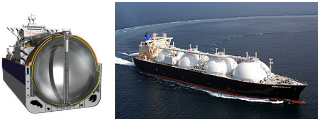
Εικόνα 2.2: Δεξαμενές τύπου Moss. (♥ Moss Maritime, Kawasaki Heavy Industries)
