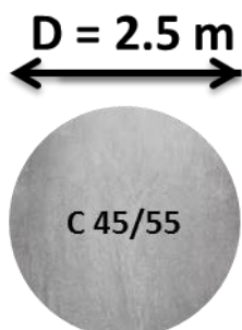
Σχήμα 2.7 : Επικάλυψη προστασίας c = 0.05\text{m} . Χρησιμοποιείται χάλυβας S400c. Χθαμαλή κατασκευή : Διαμήκης οπλισμός \rightarrow 65 \text{ } \varnothing 32 και εγκάρσιος οπλισμός \rightarrow \varnothing 14 / 8 .
