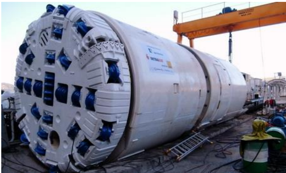
Εικόνα 11: Το TBM με διπλή ασπίδα που χρησιμοποιήθηκε στην σήραγγα Αποσελέμη (JAEGER-BAU, 2016)
