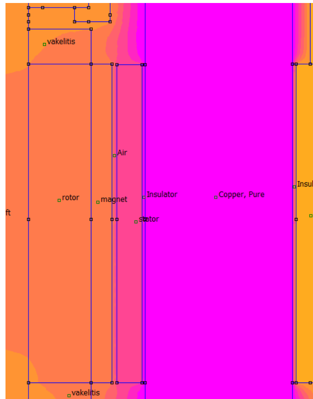
Σχήμα 5.24 – Λεπτομέρεια παράλληλης τομής στους μόνιμους μαγνήτες και στο τύλιγμα
