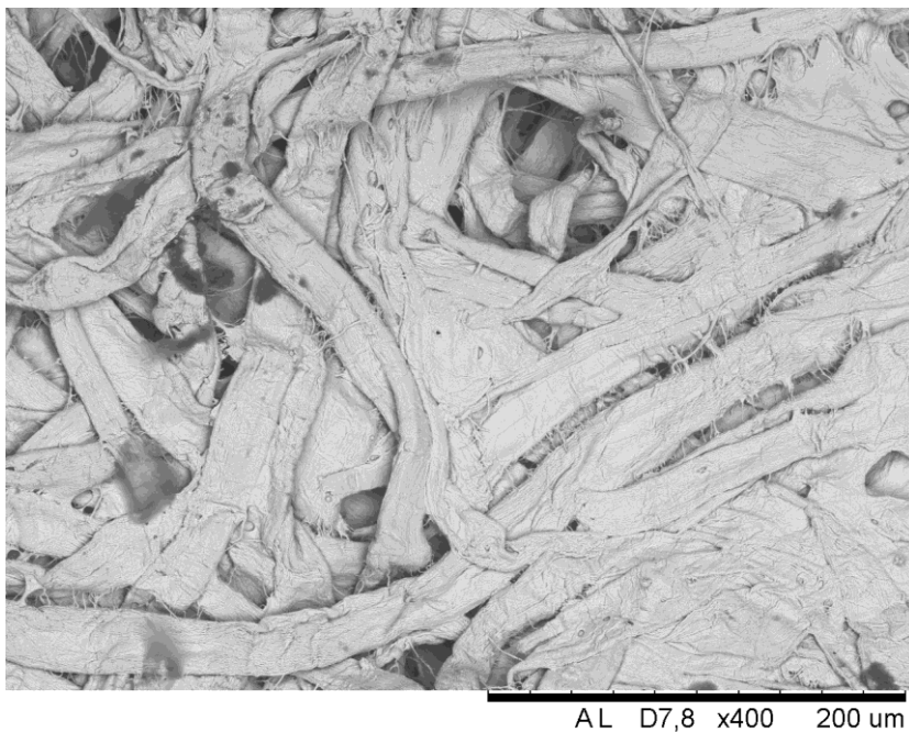
Εικόνα 5.2 Στην εικόνα αυτή φαίνονται κάποιες ατέλειες, τα μελανά σημεία στα οποία η επικάλυψη δεν έχει πετύχει.
