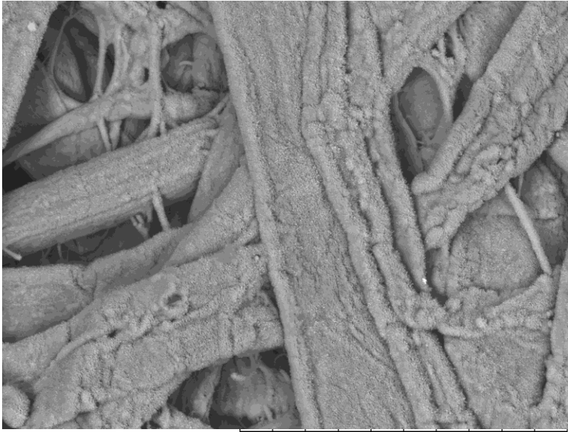
Εικόνα 5.37 Φαίνονται οι μικρές κουκίδες στην επιφάνεια της επικάλυψης Zn, Zn-ΔO.
