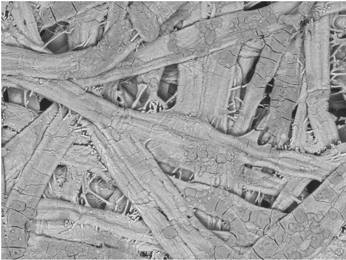
Εικόνα 5.55Επικάλυψη μαγνησίου με ρωγματώσεις, πλευρά μαγνησίου, Sn-Δ0.
