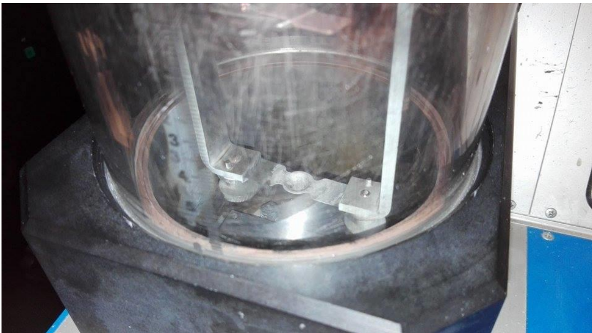
Εικόνα 3.10 Boat τοποθετημένο εντός του θαλάμου κενού. Στηρίζεται από δύο βραχίονες οι οποίοι μεταφέρουν το ρεύμα σε αυτό.
