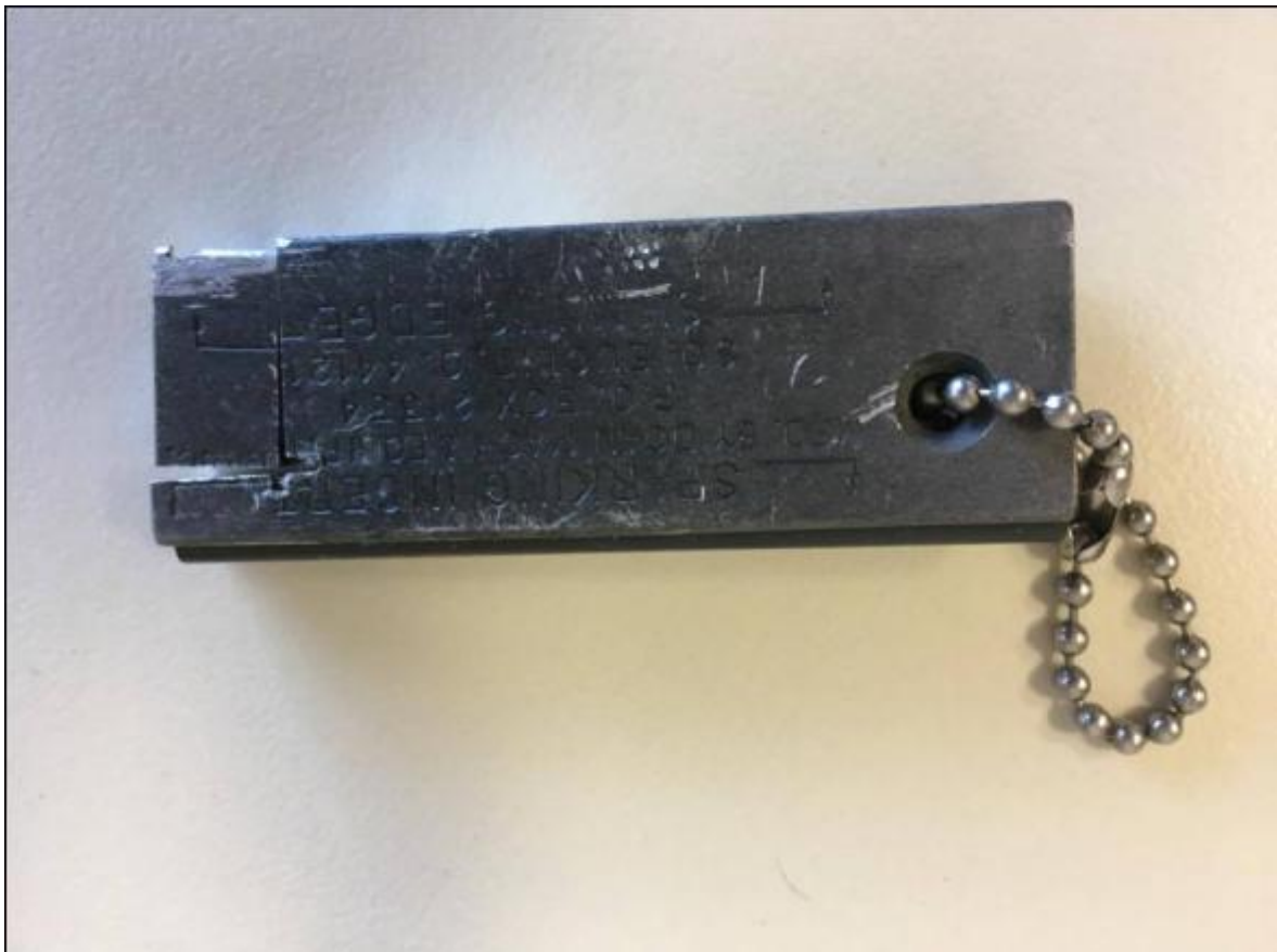
Εικόνα 3.4 Block μαγνησίου, πάνω αριστερά φαίνεται το κομμάτι που κόπηκε με τροχό
