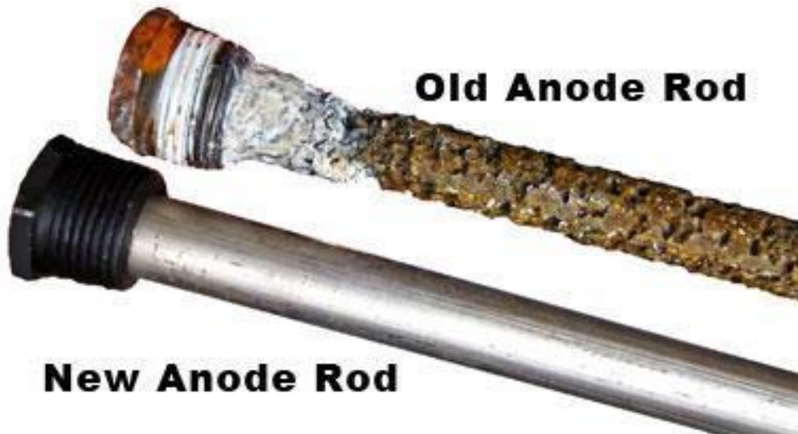
Σχήμα 1.4 Άνοδος που χρησιμοποιείται για ανοδική προστασία σε θερμοσίφωνα.
