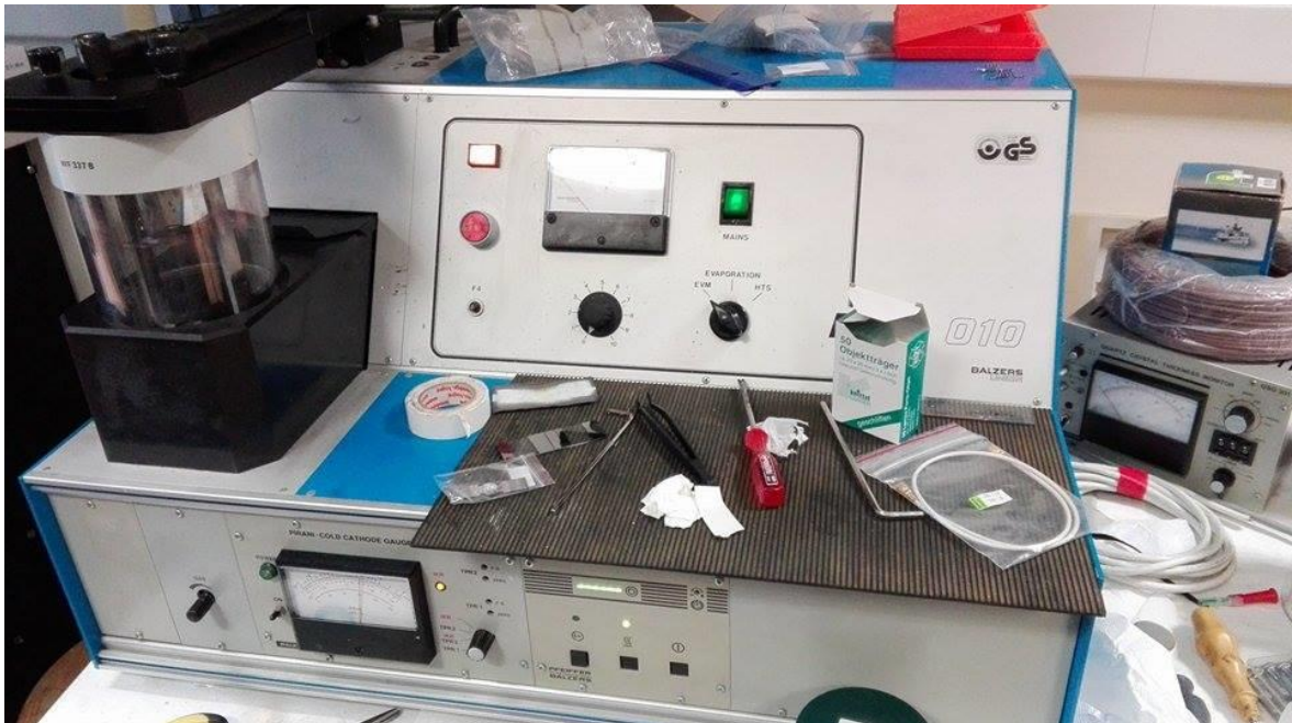
Εικόνα 3.9 Σύστημα θερμικής εξάχνωσης BALZERS 010
