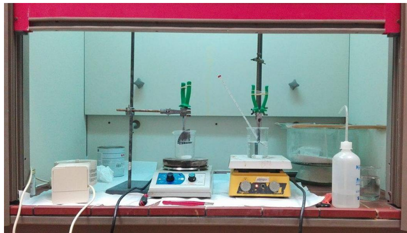
Εικόνα 34. Πειραματική διάταξη για χημική αποξείδωση με NaOH.
