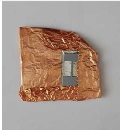
Εικόνα 31. Κάλυψη υποστρώματος πυριτίου με μάσκα από φύλλο χαλκού
