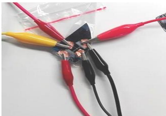
Εικόνα 50. Πειραματική διάταξη για παλμική διέγερση με ρεύμα
