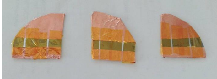
Εικόνα 38. Προετοιμασία δειγμάτων για εναπόθεση αλούμινας
