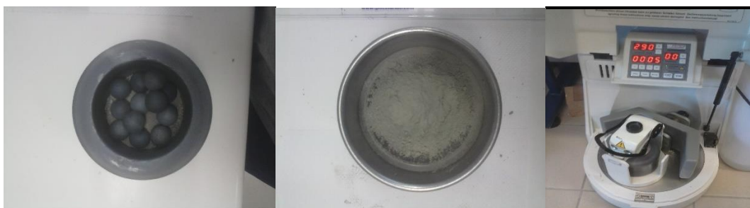
Εικόνα 3.3: Από αριστερά προς δεξιά εμφανίζονται α) το δοχείο αχάτη στο οποίο τοποθετείται το δείγμα για να κονιοποιηθεί, β) τριμμένο δείγμα στο κόσκινο και γ) ο ειδικός μηχανικός μύλος.
