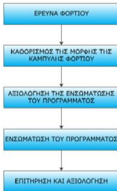
Εικόνα 3.7: Σχηματική απεικόνιση των βασικών βημάτων για την ενσωμάτωση του DSM στην Ελλάδα (Παναπακίδης Ι., 2012)
