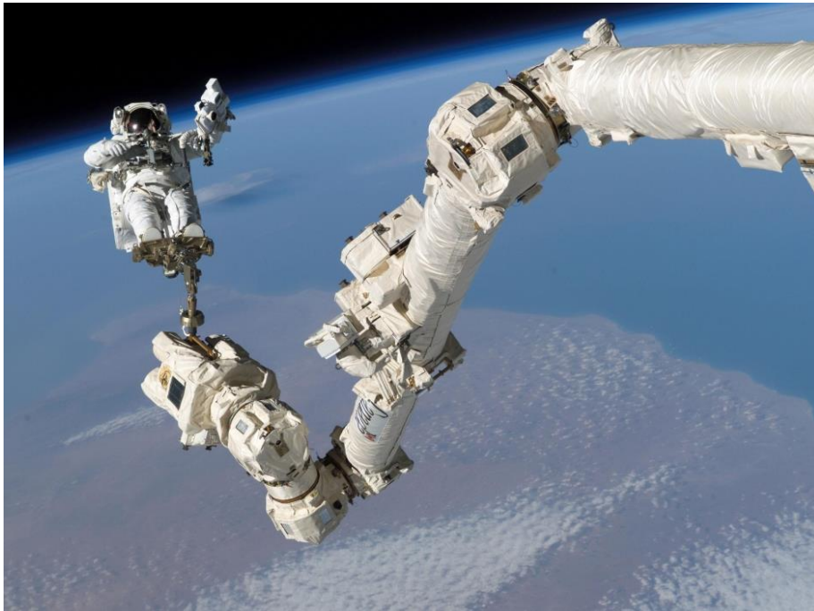
Σχήμα 1-6. Ρομποτικός βραχίονας Canadarm.
