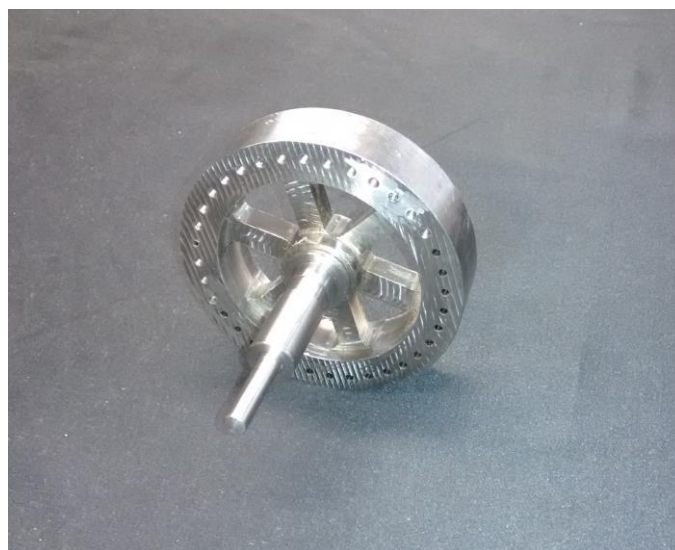
Σχήμα 5-3. Σφόνδυλος αντίδρασης του ρομπότ “Cepheus”.
