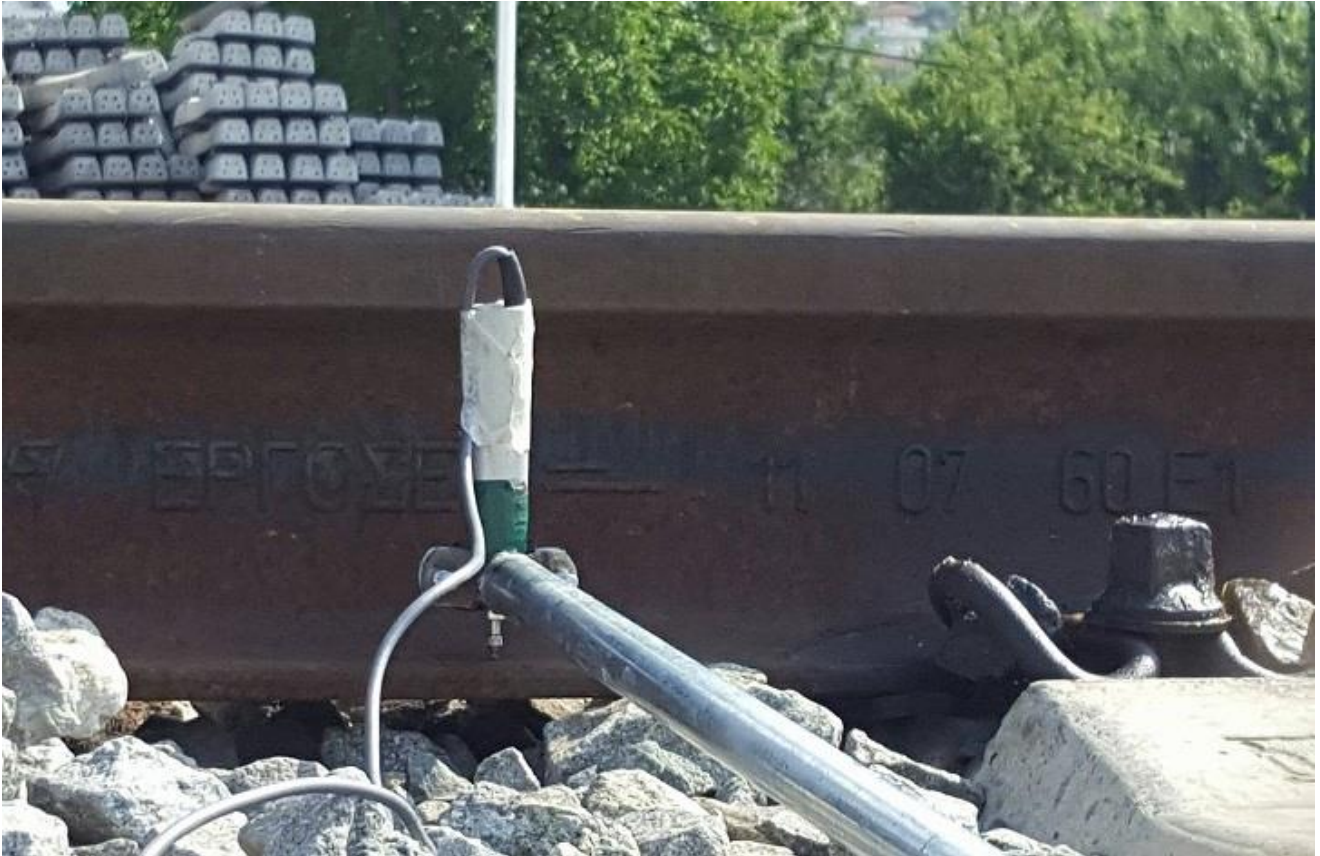
Εικόνα4.12: Τοποθέτηση μηκυσιομέτρου (Τελικές Μετρήσεις στο Σ.Σ. Λιανοκλαδίου)
