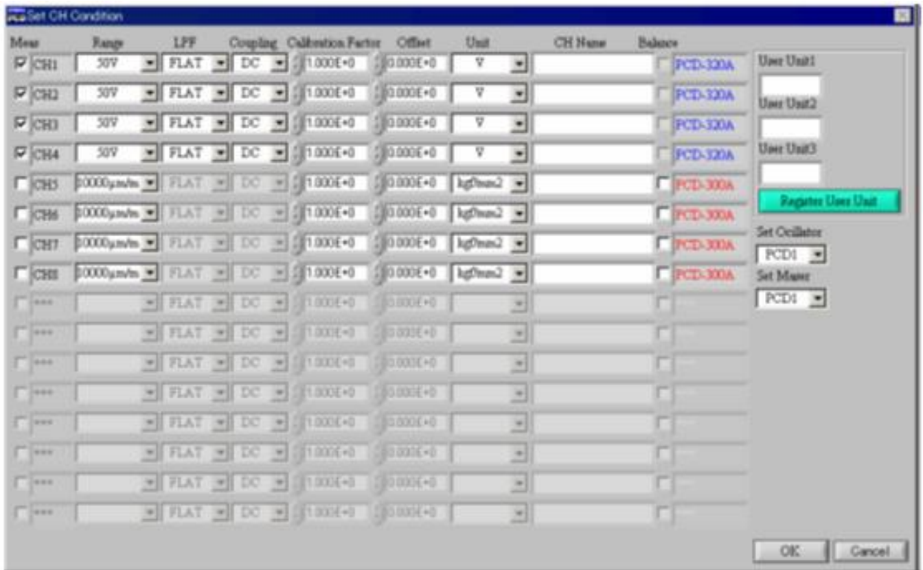
Εικόνα 4.8: Παράθυρο επιλογής «Set CH Condition»
