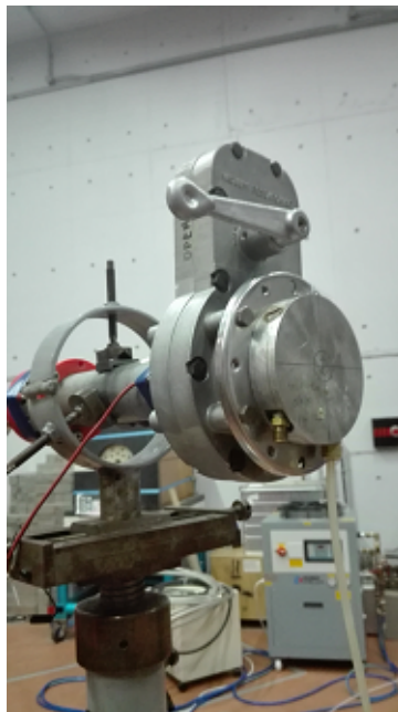
Σχήμα 3.3: ο στόχος Τριτίου όπως αυτός είναι τοποθετημένος στο τέλος της πειραματικής γραμμής που χρησιμοποιείται σε πειράματα που απαιτούν δέσμη νετρονίων
