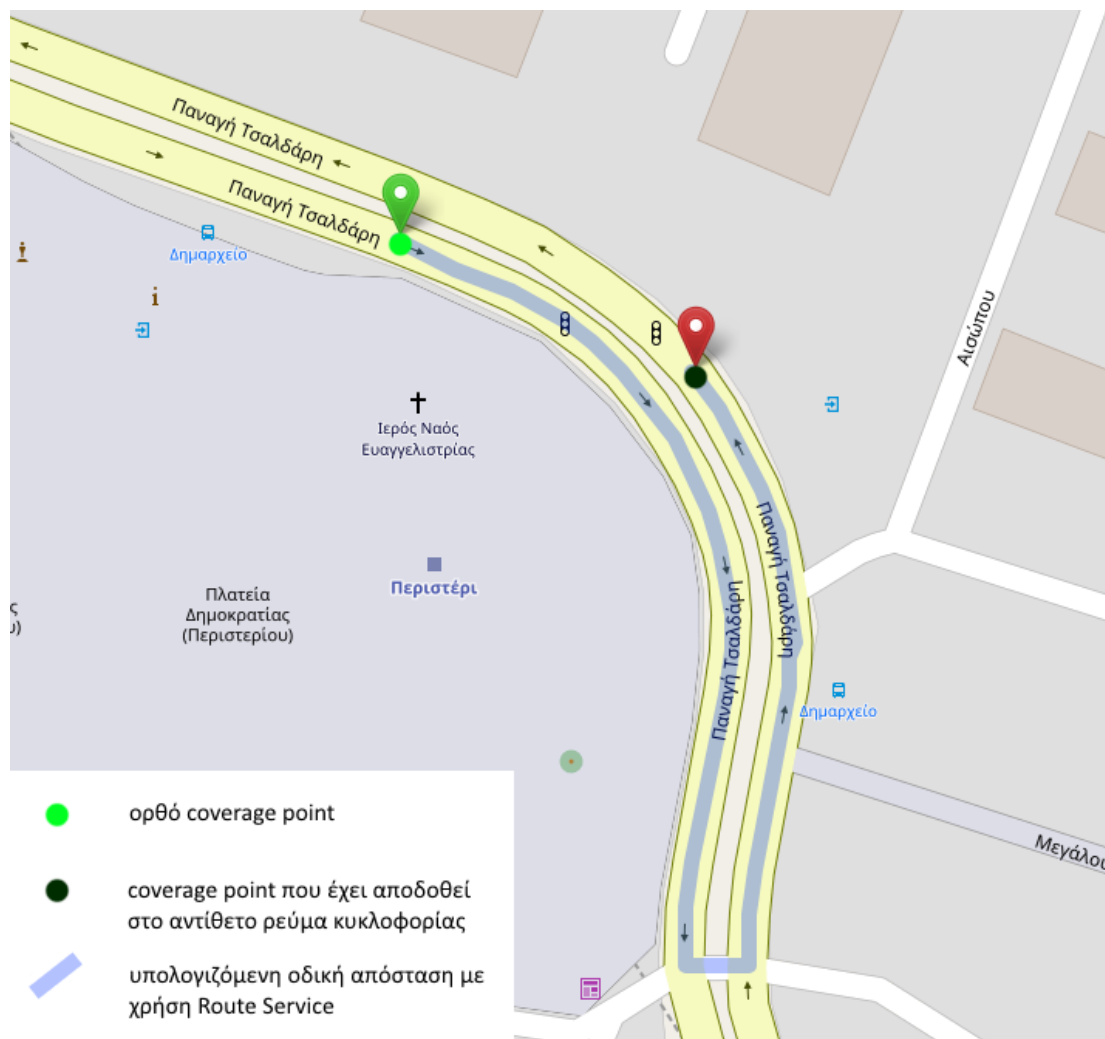
Εικόνα 6.7: Σφάλμα GPS και υπολογισμός απόστασης με Route Service
