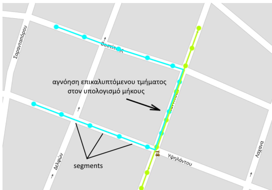
Εικόνα 6.6: Εύρεση οδικών τμημάτων με χρήση Route Service
