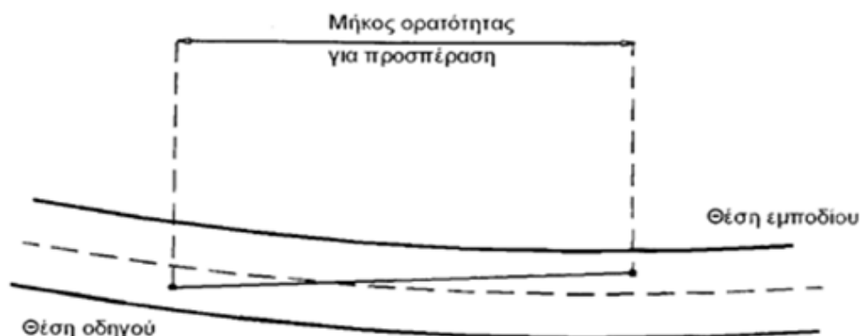
Σχήμα 2.7: Θέση οδηγού και εμποδίου για τον προσδιορισμό του μήκους ορατότητας για προσπέραση [16]
