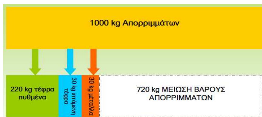
Σχήμα 6.9-1: Μείωση του βάρους των στερεών απορριμμάτων μετά από την επεξεργασία σε μονάδα θερμικής επεξεργασίας.
