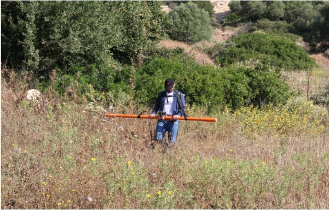
Εικόνα 5.5: Ηλεκτρομαγνητικές μετρήσεις με τη χρήση οργάνου CMD-2 σε βάθος διασκόπησης 3 m , στη θέση Λιβάδι
