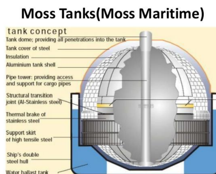
Εικόνα 3 Moss Tank της εταιρείας Moss Maritime (Πηγή www.slideshare.net/ )
