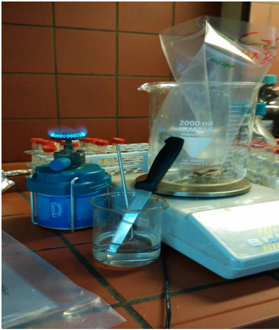
Εικόνες 3.3.9. (αριστερά) και 3.3.10. (δεξιά): Διαδικασία τεμαχισμού και μέτρησης δείγματος (αριστερά) και Ομογενοποιητής bagmixer της interscience (δεξιά).
