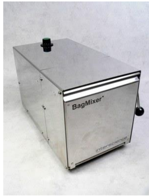
Εικόνες 3.3.9. (αριστερά) και 3.3.10. (δεξιά): Διαδικασία τεμαχισμού και μέτρησης δείγματος (αριστερά) και Ομογενοποιητής bagmixer της interscience (δεξιά).
