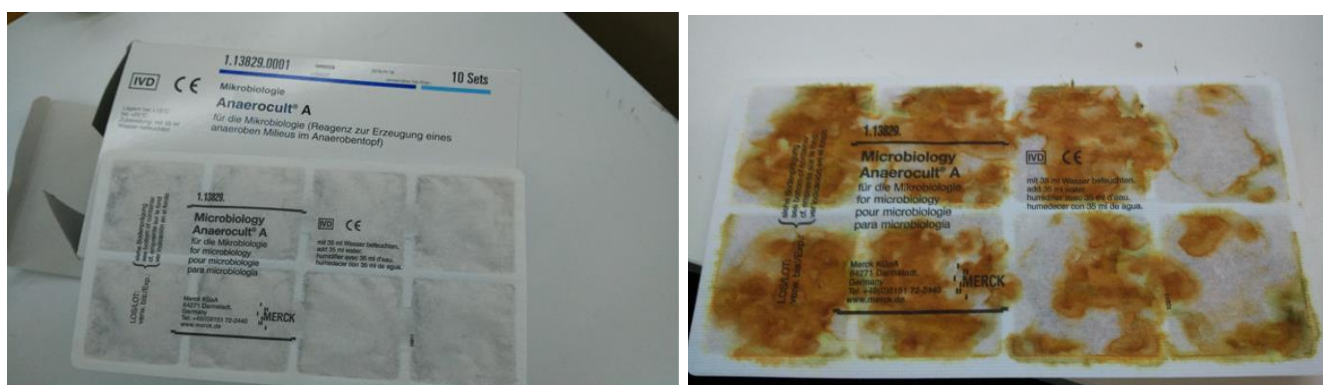
Εικόνα 3.3.15: Καταλύτης αναερόβιων συνθηκών Anaerocult® πριν (Αριστερά) και μετά (Δεξιά) την χρήση του.
