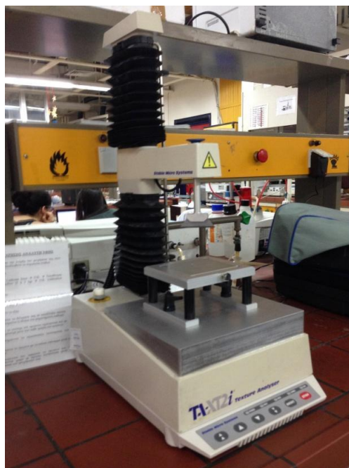
Εικόνα 3.3.4.: Αναλυτής υφής TA-XT2 με προσαρμοσμένη λεπίδα κοπής TA-4
