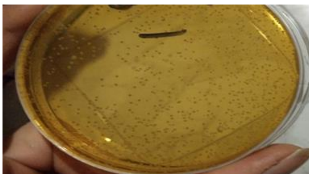
Εικόνα 3.3,16: Καταμέτρηση αποικιών σε τριβλίο με υπόστρωμα TOS-MUP
