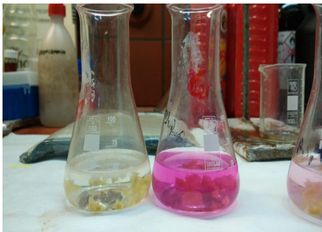
Εικόνες 3.3.5.: Αλλαγή του χρώματος του δείκτη φαινολοφθαλείνης (αριστερά), τυχαία στιγμή κατά τη διάρκεια της ογκομέτρησης (δεξιά).
