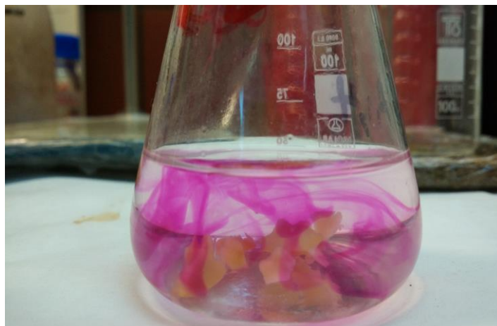
Εικόνες 3.3.5.: Αλλαγή του χρώματος του δείκτη φαινολοφθαλείνης (αριστερά), τυχαία στιγμή κατά τη διάρκεια της ογκομέτρησης (δεξιά).
