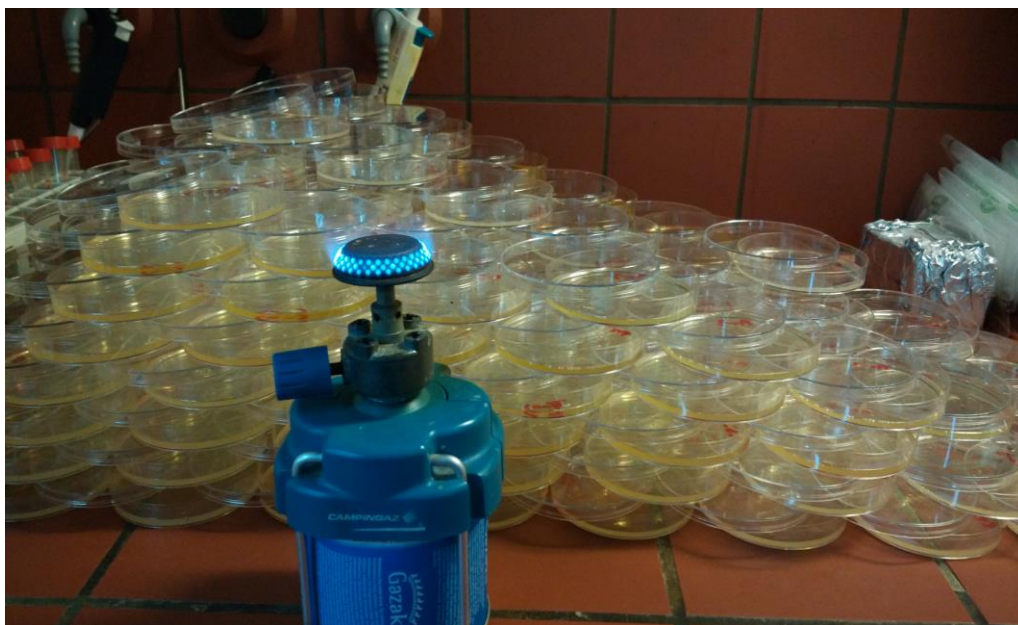
Εικόνα 3.3.13.: Σταθεροποίηση υποστρώματος τριβλίων MRS-CysHCl και TOS-MUP σε διάταξη πυραμίδας
