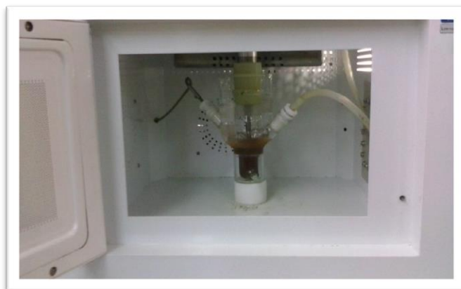
Εικόνα 18: Δοχείο εκχύλισης με κακάο και πετρελαϊκό αιθέρα εντός της συσκευής εκχύλισης με μικροκύματα
