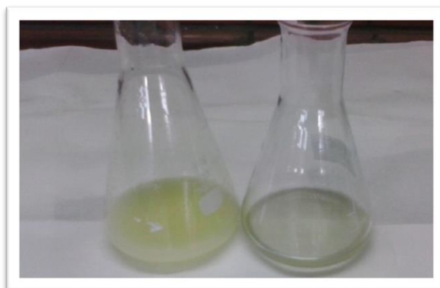
Εικόνα 21: Η δεξιά κωνική φιάλη περιέχει βούτυρο κακάο διαλυμένο στον οργανικό διαλύτη, ενώ η αριστερή περιέχει το διάλυμα αυτό και KI. Το κίτρινο χρώμα οφείλεται στον σχηματισμό \text{I}_2
