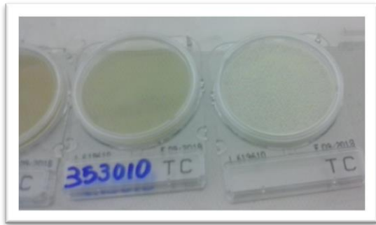
Εικόνα 15: Αποστειρωμένα τρυβλία με ξηρό θρεπτικό υλικό για την ανάπτυξη του ολικού μικροβιακού φορτίου
