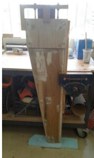
Εικόνα 5.7: Ένωση των τμημάτων της καρίνας
