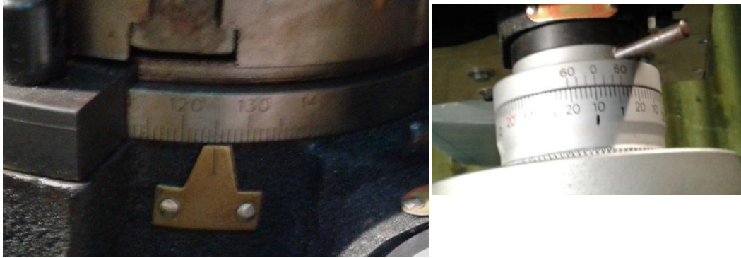
Εικόνα 5.14: Μετρητική ένδειξη διαιρέτη 5.14.1: Μοίρες 5.14.2: υποδιαίρεση της μοίρας
