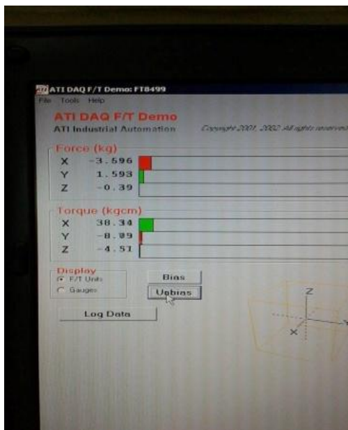
Εικόνα 5.10: Φόρτιση του οργάνου και εξαγωγή αποτελεσμάτων σε Kgκαι Kg*cm με χρήση της συνάρτησηςμεταφοράς του κατασκευαστή.
