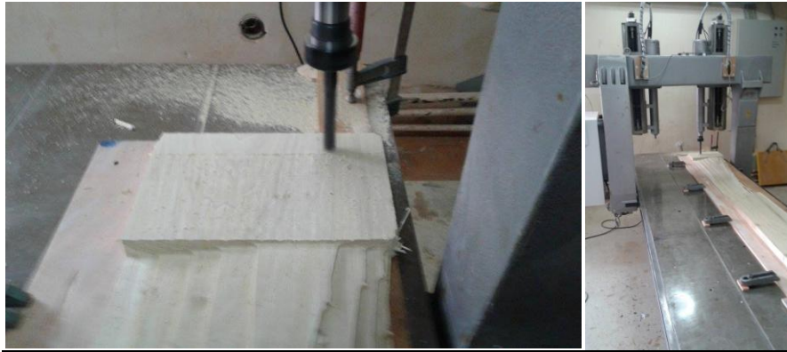
Εικόνες 5.5: 5.5.1 Η φρέζα και το άνω τμήμα στήριξης της καρίνας (ορθογώνιο ενσωματωμένο τμήμα ξύλου για καλύτερη στήριξη), 5.5.2 διάταξη φρέζας όπου φαίνονται οι τάκοι στήριξης των ξύλινων τεμαχίων
