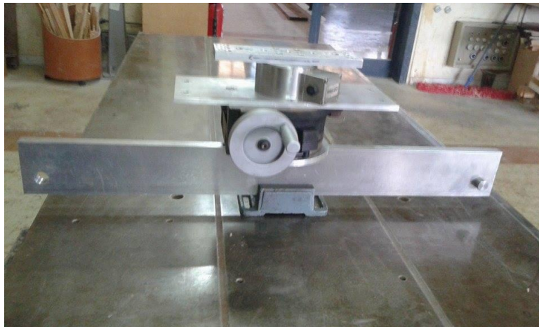
Εικόνα 5.15: Ολοκληρωμένη διάταξη όπου φαίνονται το δυναμόμετρο, ο διαιρέτης και η δοκός στήριξης της κατασκευής σε ανάστροφη φορά.
