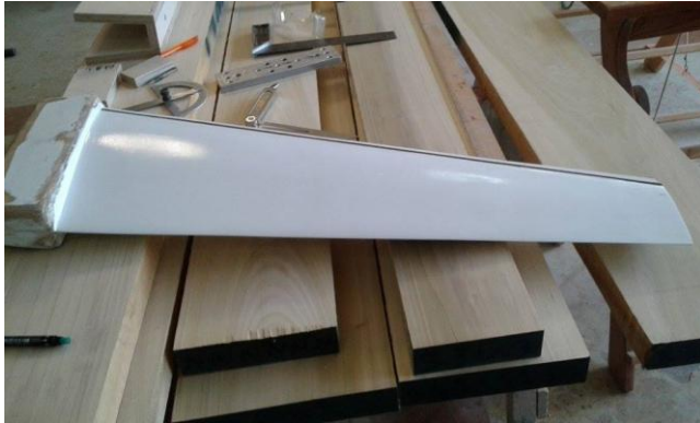
Εικόνες 5.19: 5.19.1:Η καρίνα διεξαγωγής των πειραμάτων, όπου είναι τοποθετημένος διεγέρτης τύρβης τύπου λωρίδας άμμου 5.19.2:Ευθυγράμμιση με laser στην τελική πειραματική διάταξη
