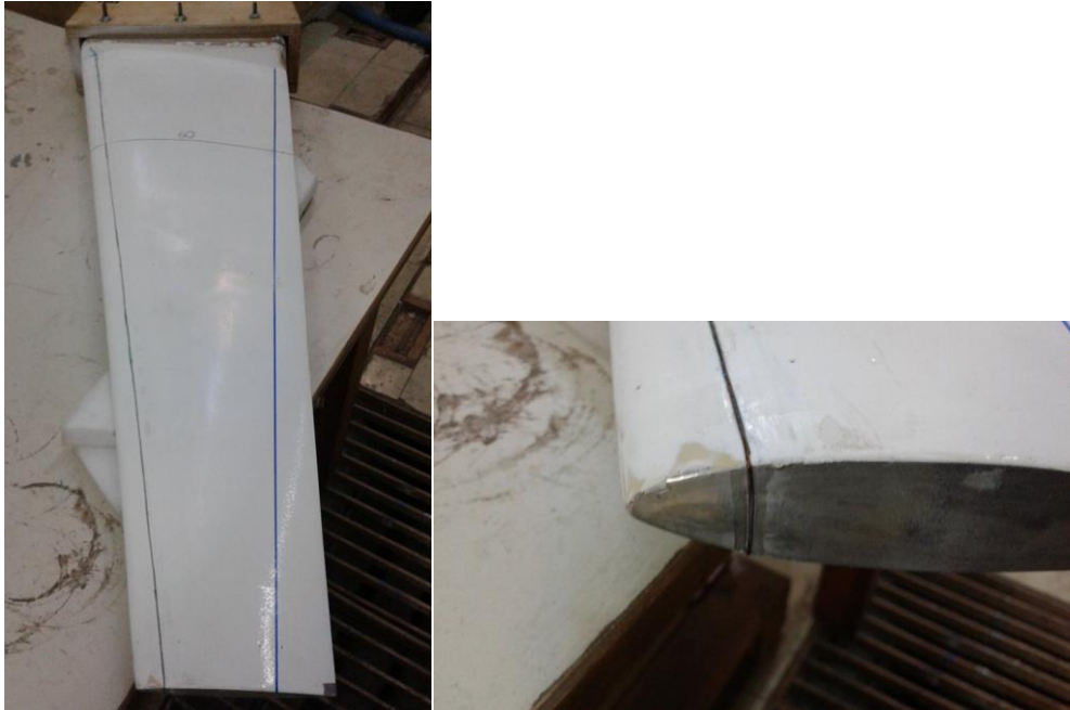
Εικόνες : 6.12.1 , 6.12.2 : Η καρίνα με τοποθετημένο το σύρμα κοντά στο χείλος πρόσπτωσης. Η μπλε γραμμή είναι η κατακόρυφη γραμμή που σημαδεύτηκε με την βοήθεια του laser και χρησιμοποιήθηκε κατά την ευθυγράμμιση.
