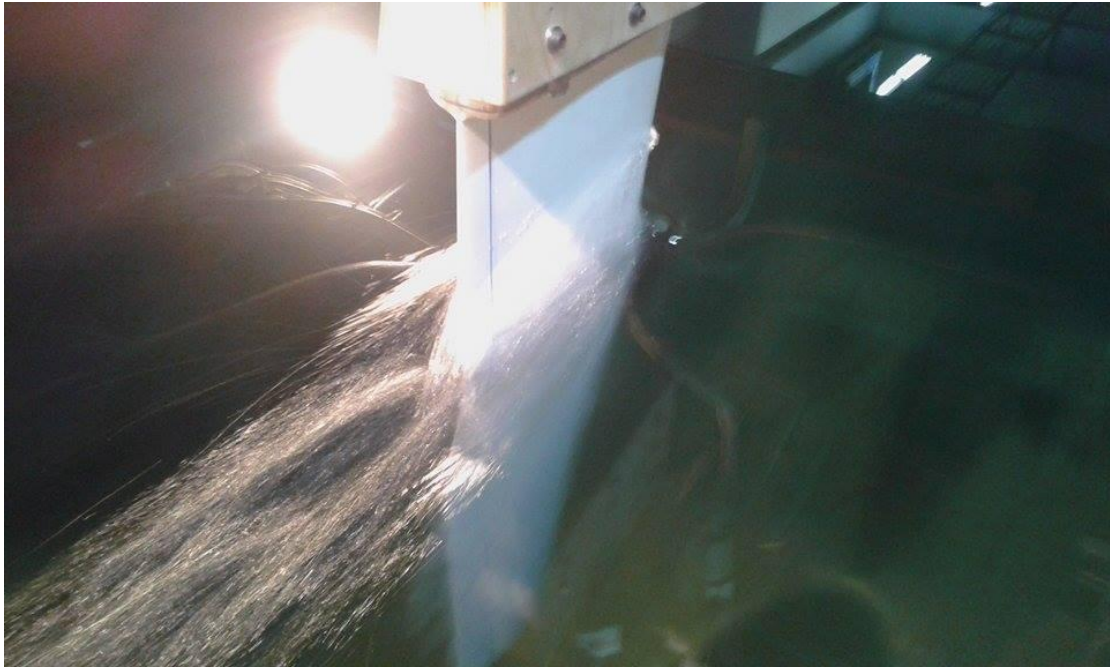
Εικόνες 6.9.1, 6.9.2 : Χωρίς διεγέρτη τύρβης, 2m/supstream
