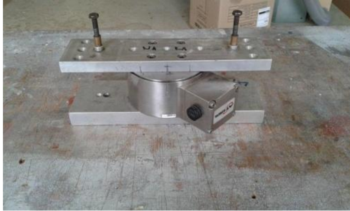
Εικόνα 5.11: Δυναμόμετρο πριν την τοποθέτησή του στην διάταξη, στο οποίο είναι και τοποθετημένες οι δύο παράλληλες μεταλλικές πλάκες στήριξης στην άνω και κάτω πλευρά του
