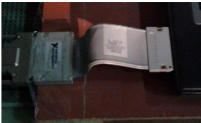
Εικόνα 5.8: Ηλεκτρονική Κάρτα η οποία συνδέει το δυναμόμετρο με τον Ηλεκτρονικό Υπολογιστή
