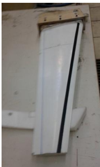
Εικόνα 6.18: Καρίνα με τοποθετημένο διεγέρτη τύρβης τύπου λωρίδας άμμου με διπλάσιο πλάτος.
