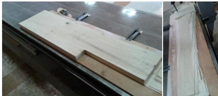
Εικόνες 5.4: 5.4.1 Το ένα εκ των δύο τμήματα της καρίνας πριν 5.5.2 μετά την αυτοματοποιημένη διεργασία
