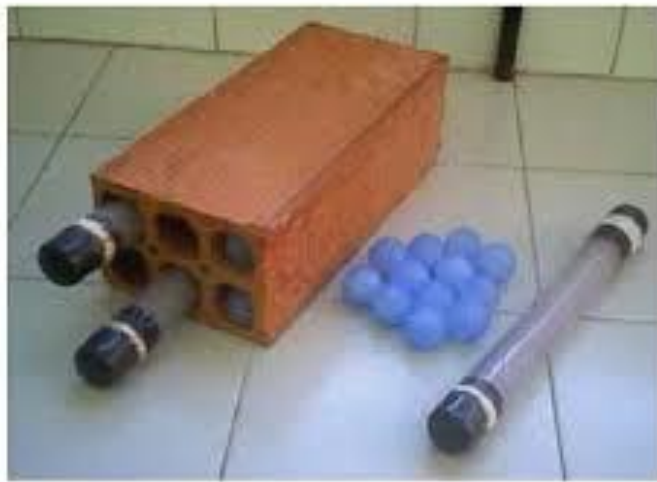
3. Τούβλο με έξι οπές και PCM σε κάψουλες και σε σωλήνες
