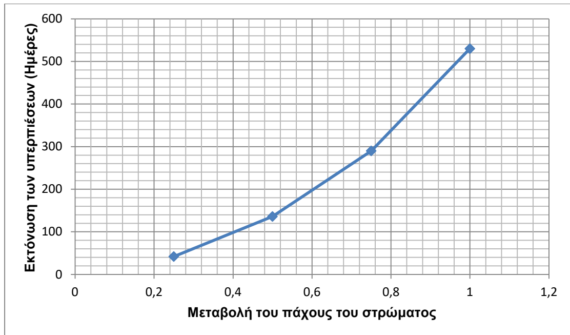
Σχήμα 4-2. Χρόνος που απαιτείται για την εκτόνωση των υπερπίεσεων των πόρων σε σχέση με την μεταβολή του πάχους του στρώματος της μαλακής αργίλου II
