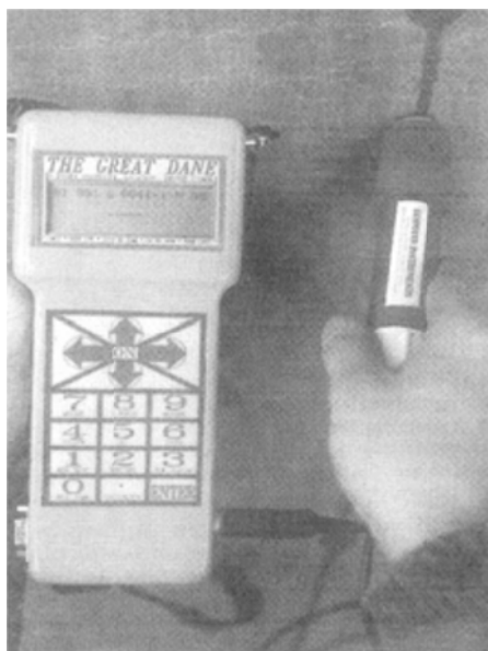
Εικόνα 2.5: Όργανο μέτρησης ηλεκτρικού δυναμικού για τον προσδιορισμό του κινδύνου διάβρωσης ράβδων οπλισμού
