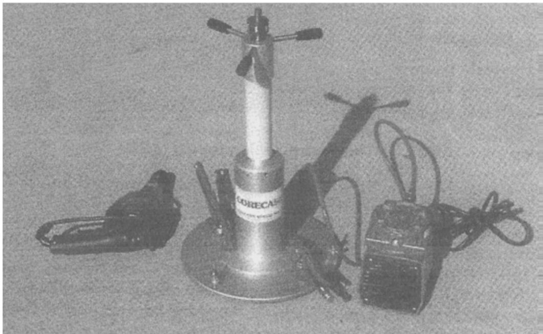
Εικόνα 2.6: Σύστημα λήψης πυρήνων σκυροδέματος
