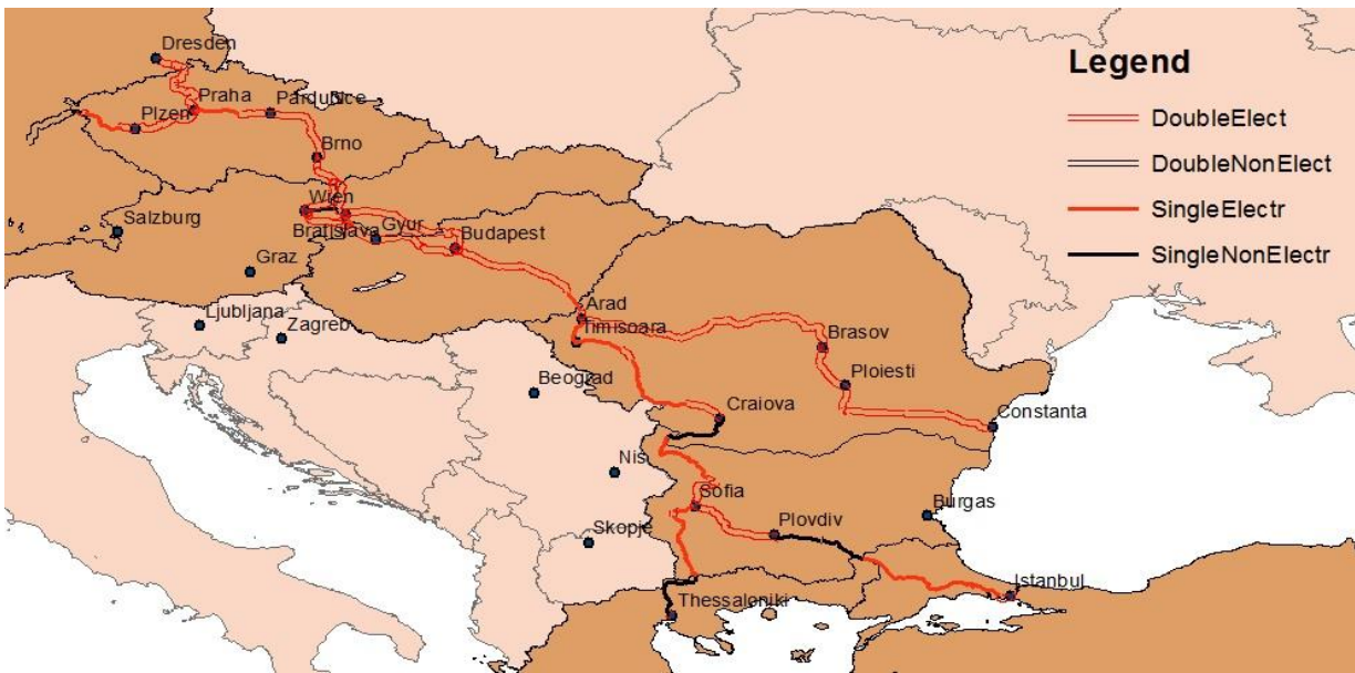
Εικόνα 37: Διάδρομος IV, μονή/διπλή γραμμή, ηλεκτροκίνηση/χωρίς ηλεκτροκίνηση
