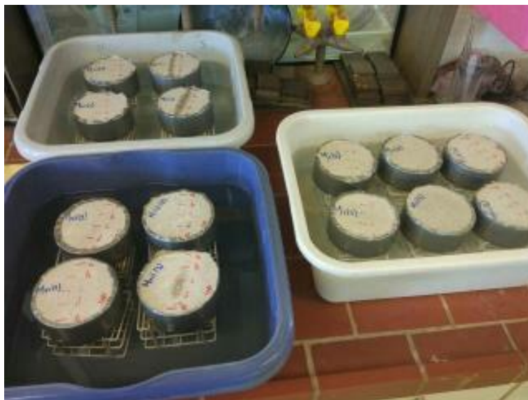
Σχήμα 4.8: Πειραματική διάταξη μέτρησης υδατοαπορροφητικότητας
