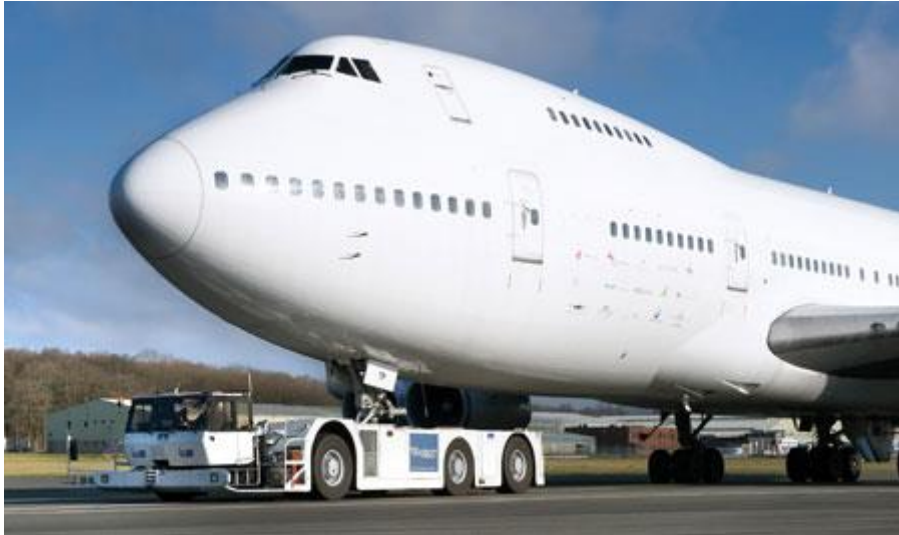
Εικόνα 5.6: Pushback κατά την μεταφορά ενός Boeing 747.
