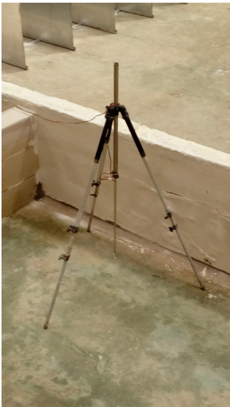
Εικ. 3.3 : Μετρητής κύματος του εργαστηρίου, τοποθετημένος πάνω σε τρίποδο
