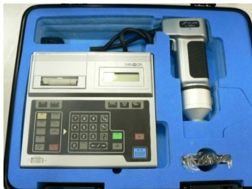
Σχήμα 4.3: Χρωματόμετρο MINOLTA CR – 200 (Aqua lab 4TEV, Decagon Devices, USA)
