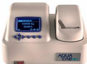
Σχήμα 4.2: Συσκευή μέτρησης ενεργότητας νερού (Aqua lab 4TEV, Decagon Devices, USA)
