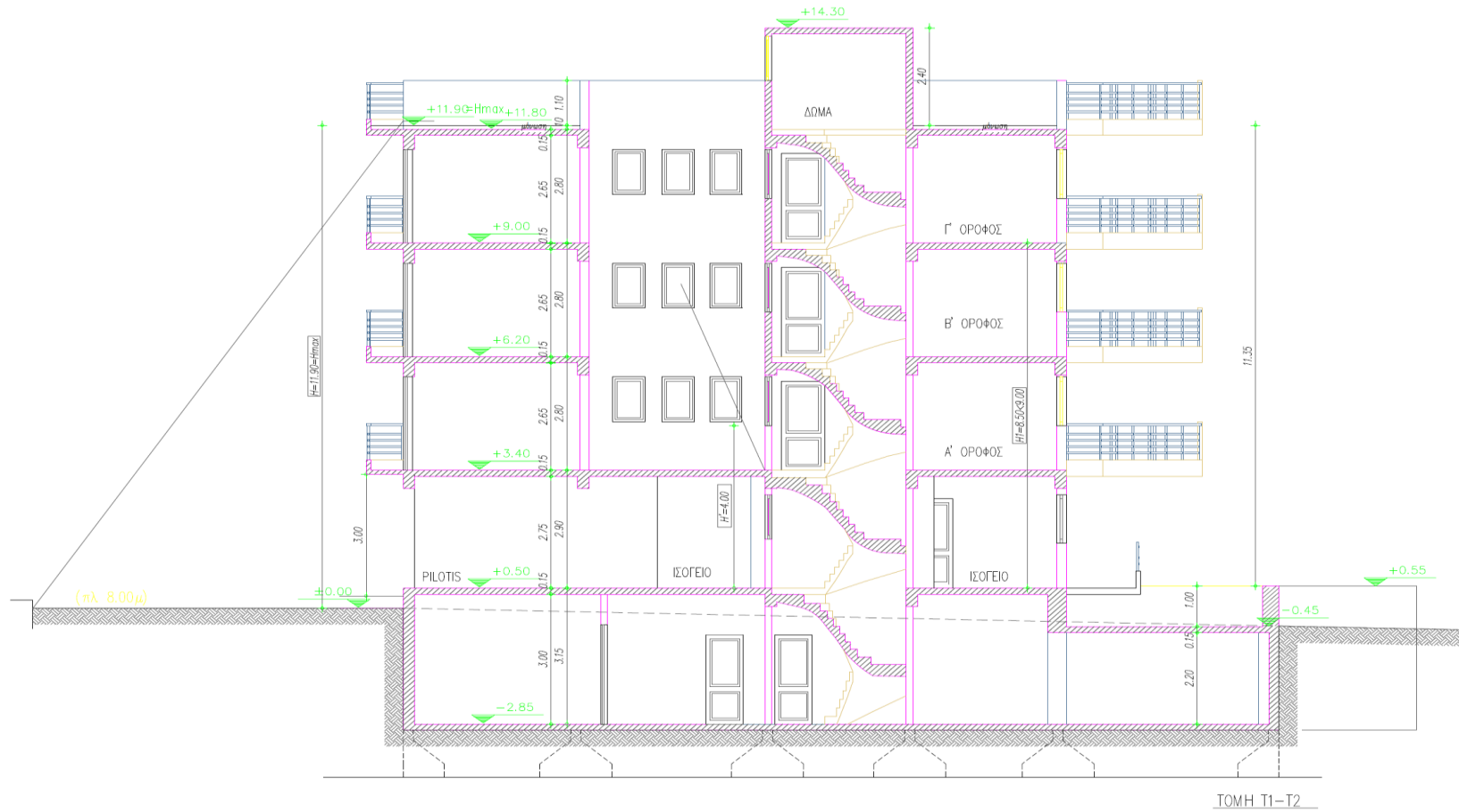
Εικόνα 2.6 : Ενδεικτική τομή κτιρίου
