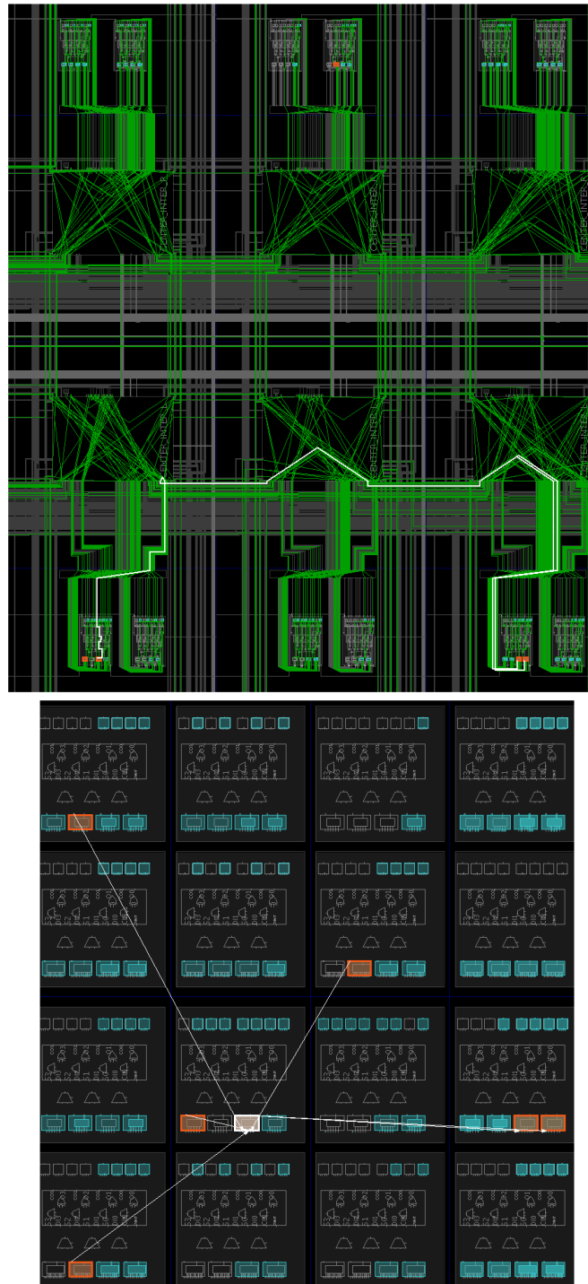
Σχήμα 4.1.III: Πραγματικό κύκλωμα σε FPGA του schematic από το σχήμα 4.1.II. Κάτω φαίνονται τα CLB του FPGA fabric (βλ. και σχήμα 1.3.III), των οποίων τα LUT συνδέονται μεταξύ τους (τα άσπρα βέλη υποδεικνύουν τη συνδεσμολογία). Πάνω μπορεί κανείς να δει το πραγματικό routing που συνδέει τα λογικά κελιά μεταξύ τους. Πρώτα το σήμα οδηγείται στο τοπικό router, ο οποίος θα προωθήσει το σήμα στο κατάλληλο LUT. Σε αυτό το σχήμα μπορεί κανείς να δει το πρόβλημα του συνωστισμού, που προκαλείται όταν πολλά λογικά κελιά καλούνται να συνδεθούν μεταξύ τους. Τότε είναι που τα race conditions στα συνδυαστικά κυκλώματα κυριαρχούν, και μπορεί να κρίνουν την τύχη ολόκληρου του design.
