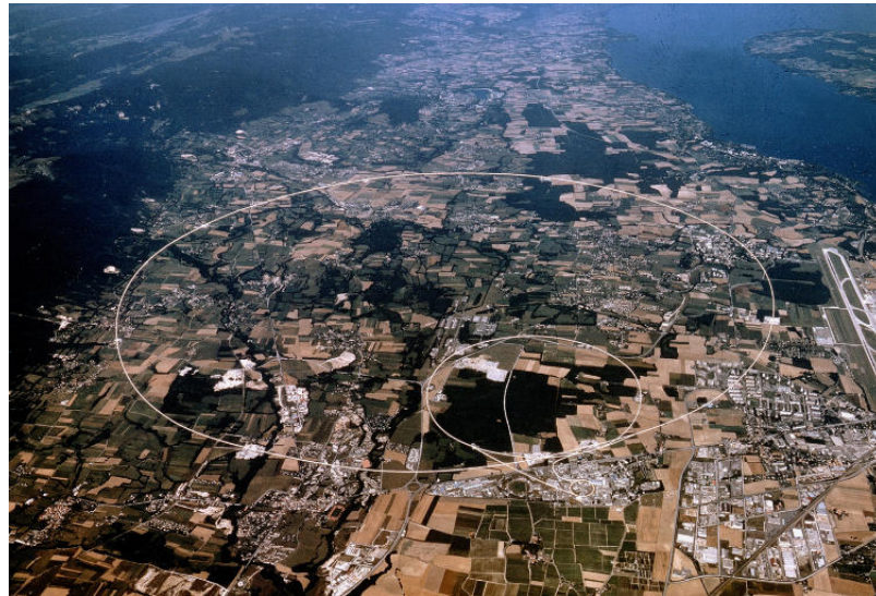
Σχήμα 5.2.1: Αεροφωτογραφία του CERN και του LHC. Είναι ευδιάκριτος ο μεγάλος δακτύλιος που επιταχύνονται τα σωματίδια, ενώ στα δεξιά φαίνεται το αεροδρόμιο και η λίμνη της Γενεύης. Ο μικρότερος δακτύλιος μέσα στον κύριο, είναι ο SPS, ο οποίος διοχετεύει τον κύριο δακτύλιο του LHC με πρωτόνια ενέργειας μερικών εκατοντάδων GeV [24].
