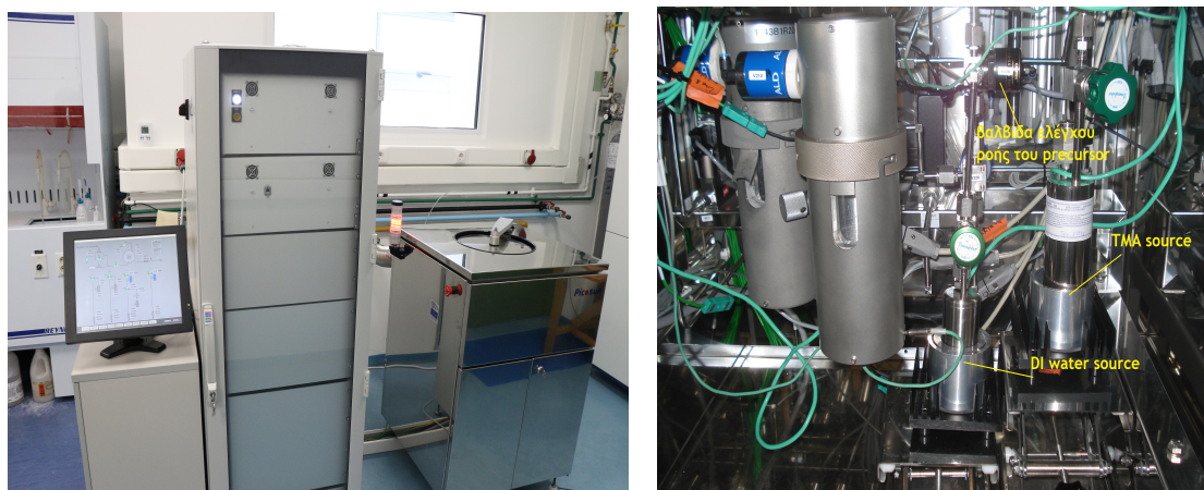
Εικόνα 2: Αριστερά, η διάταξη ALD του εργαστηρίου. Δεξιά, το εσωτερικό του ίδιου συστήματος: δοχεία που περιλαμβάνουν τις πρόδρομες ενώσεις (TMA, H 2 O), σύστημα ελέγχου ροής των πρόδρομων ενώσεων, σύστημα θέρμανσης των δοχείων των πρόδρομων ενώσεων και αντλία κενού.
