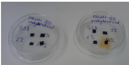
Εικόνα 4. Επιφάνειες νιτριδίου του πυριτίου κατεργασμένες με NaOH μετά από προσθήκη διαφόρων συγκεντρώσεων PAMAM
