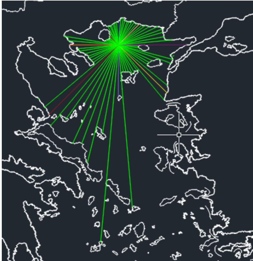
Εικόνα 3.2 Αναπτύγματα πελάγους γύρω από το σημείο μελέτης( Autocad 2015)
