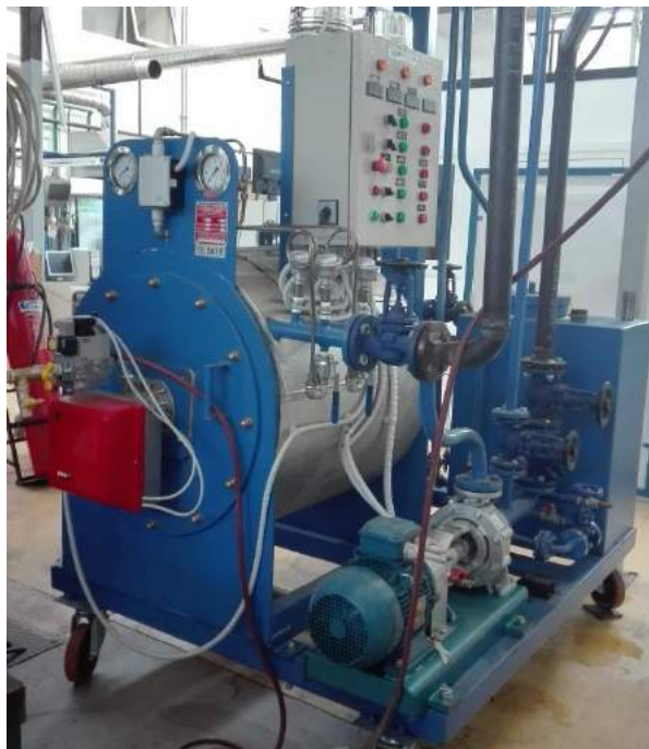
Εικόνα 2.3 Κύκλωμα θερμικού ελαίου
