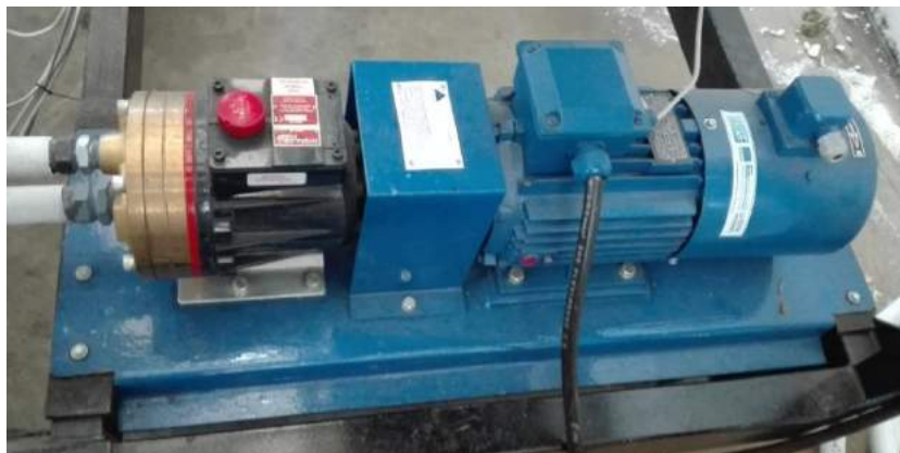
Εικόνα 2.16 Σύστημα αντλίας – κινητήρα
