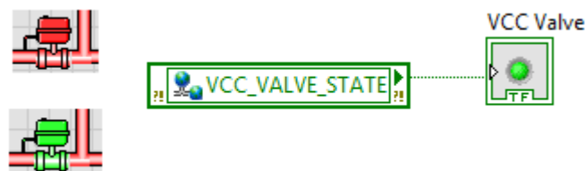
Εικόνα 3.47 Σύνδεση κοινής μεταβλητής με γραφικό στοιχείο ελέγχου
