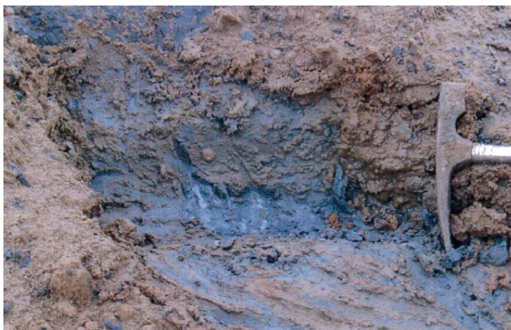
Εικόνα 3.25: Εμφανιζόμενη πιθανή επιφάνεια ολίσθησης (ΧΘ 11+000)
