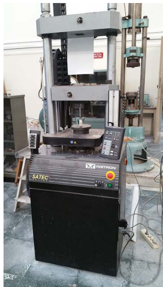
Σχήμα 9: Μηχανή Instron 300kN και δοκίμιο τοποθετημένο στη μηχανή.
