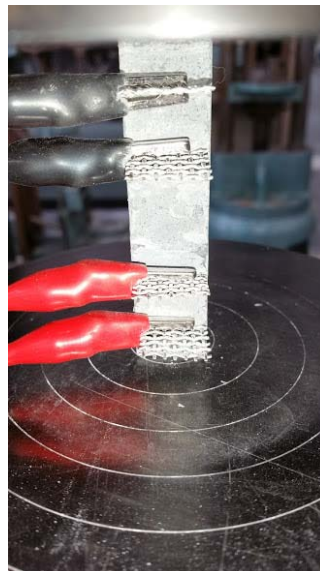
Σχήμα 9: Μηχανή Instron 300kN και δοκίμιο τοποθετημένο στη μηχανή.
