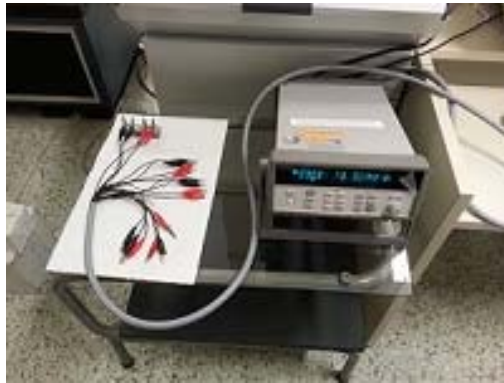
Σχήμα 8: Καταγραφικό Agilent 34970a κατάλληλο για την απασχολημένη μέτρηση της ηλεκτρικής αντίστασης με τη μέθοδο των δύο και τεσσάρων καλωδίων.
