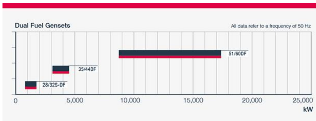
Εικόνα 5.11: Πλήρης γκάμα ισχύος τετράχρονων κινητήρων μεικτής καύσης της εταιρίας MAN Diesel & Turbo
