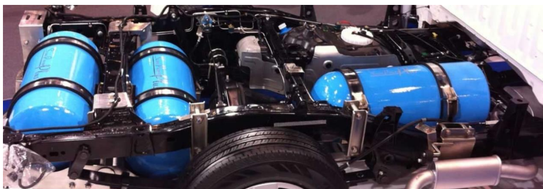
Εικόνα 3.6: Δεξαμενές CNG σε όχημα βαρέως τύπου
