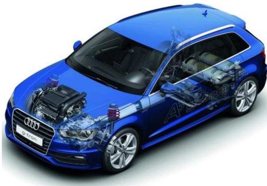
Εικόνα 3.5: Εφαρμογή καύσης CNG σε κινητήρα σπινθηρισμού
