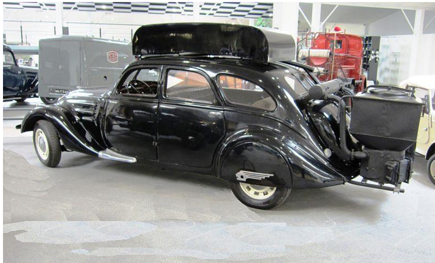
Εικόνα 3.1: Λιμουζίνα της Peugeot (μοντέλο 402) προσαρμοσμένη ώστε να λειτουργεί με αέριο που παράγεται από την καύση του άνθρακα (κοκ). Παράχθηκαν 2500 μονάδες μεταξύ 1940 και 1945.
