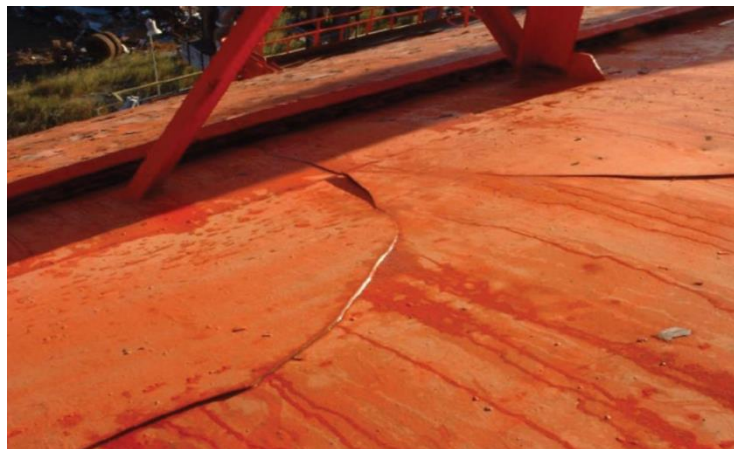
Εικόνα 5.4: Ρηγμάτωση στο κατάστρωμα πλοίου λόγω διαρροής LNG
