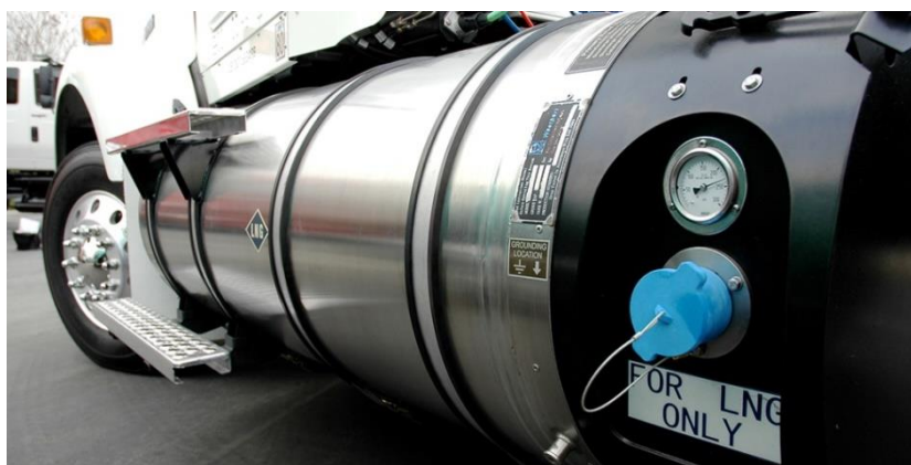
Εικόνα 3.7: Δεξαμενή LNG σε όχημα βαρέως τύπου
