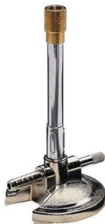
Εικόνα 2.3: Ένας τυπικός καυστήρας-λύχνος Bunsen.
