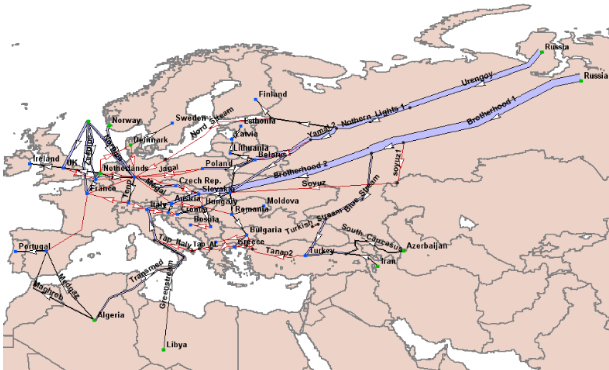
Σχήμα 65: Σχηματική απεικόνιση της ροής των αγωγών φυσικού αερίου ως αποτέλεσμα της επίλυσης MCF μέσω του TransCAD (χωρίς βαθμονόμηση).
