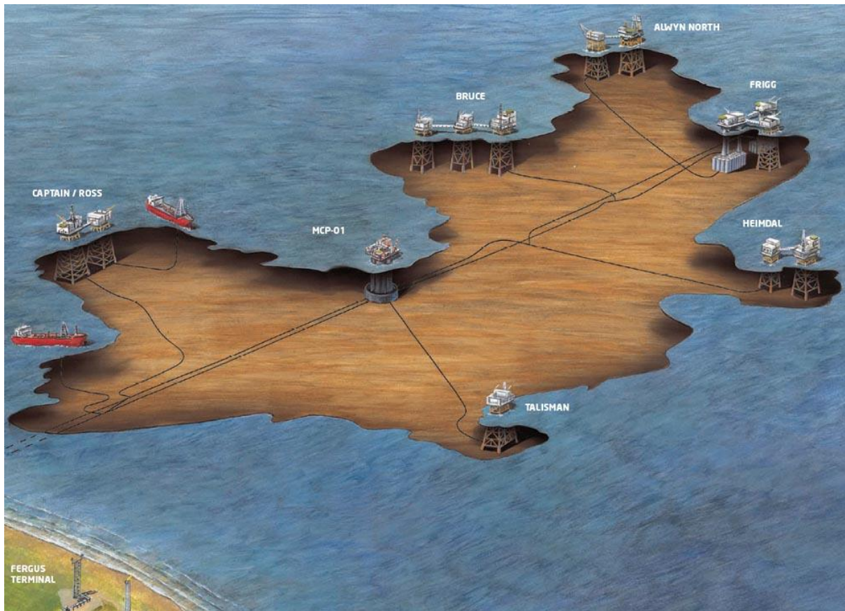
Σχήμα 32: Το σύστημα μεταφοράς Frigg.
