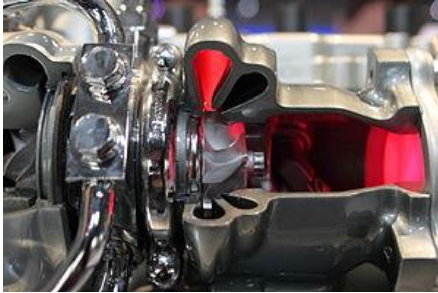
Εικόνα 34 Τομή Twin-scroll στροβιλοσυμπιεστής
