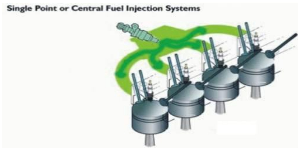
Εικόνα 27 Σύστημα ψεκασμού καυσίμου ενός σημείου (SPI)
