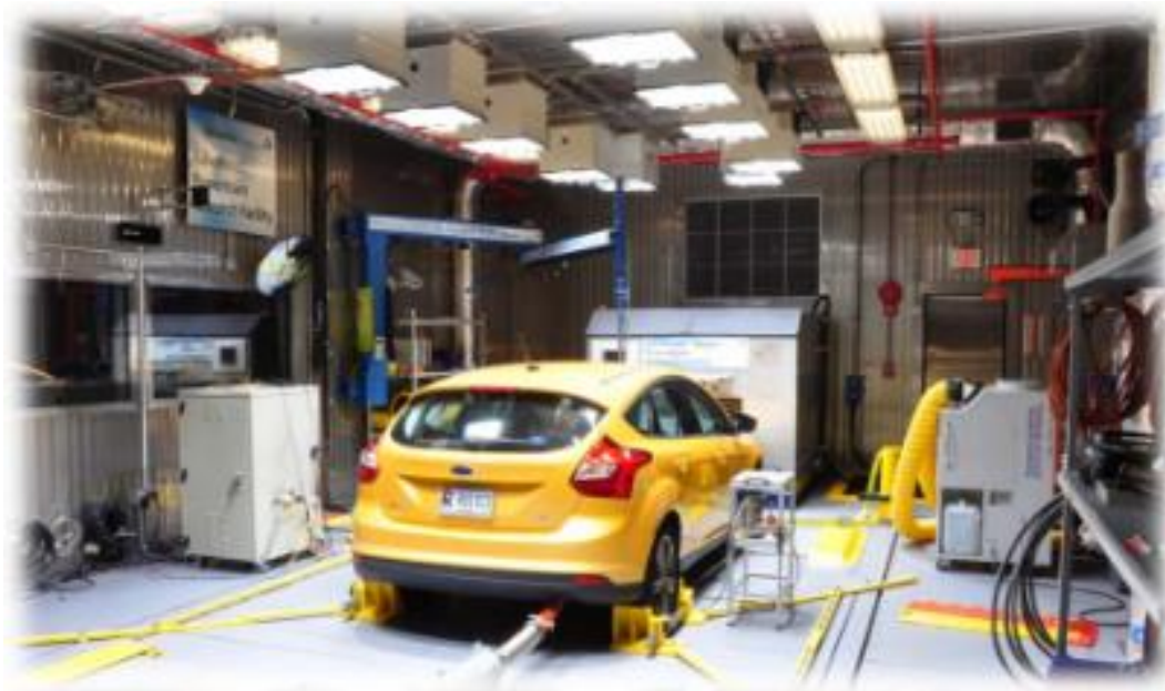
Εικόνα 55 Δυναμόμετρο προσομοίωσης οδηγικού κύκλου με μέτρηση εκπομπών
