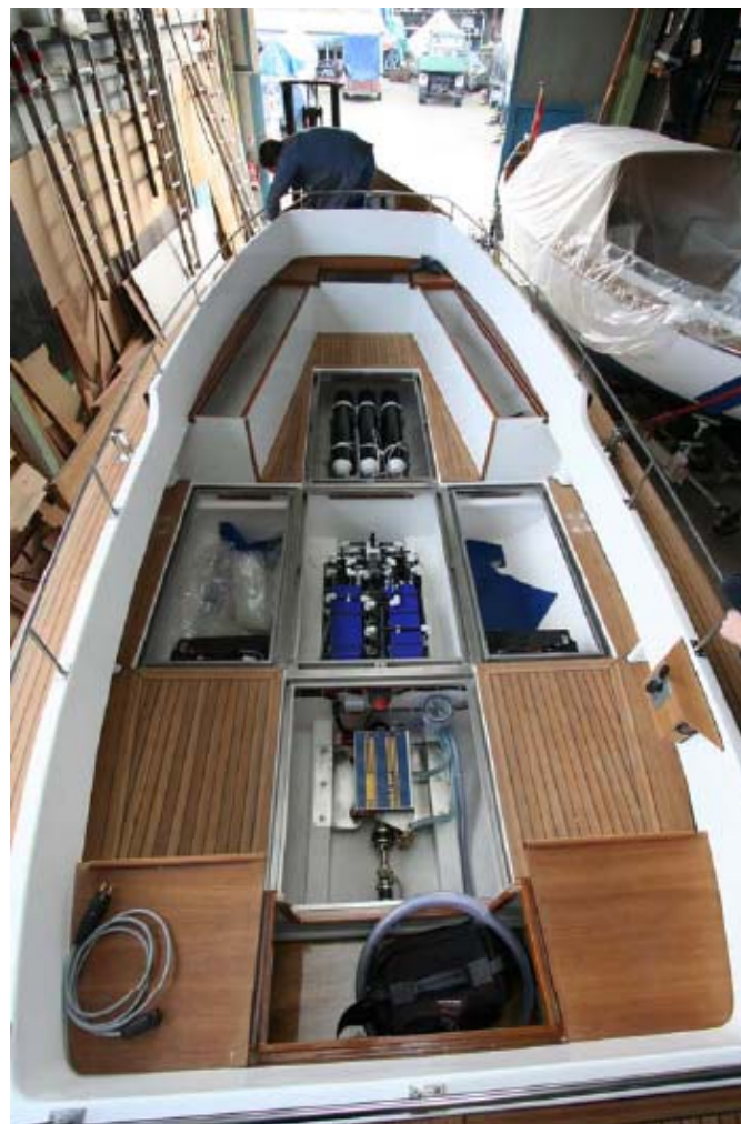
Εικόνα 3.2 Το εσωτερικό του H 2 Yacht 675, διακρίνονται από την πλώρη προς την πρύμνη οι φιάλες αποθήκευσης του H 2 , οι κυψέλες καυσίμου και ο ηλεκτρικός κινητήρας πρόωσης [30].
