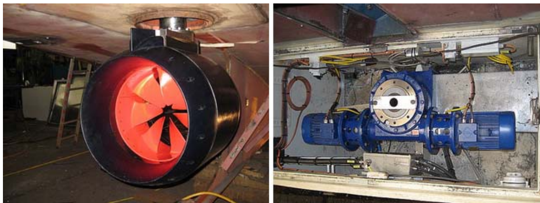
Εικόνα 3.10 Ο ηλεκτρικός κινητήρας πρόωσης και το ηλεκτρομηχανικό σύστημα περιστροφής του [36].
