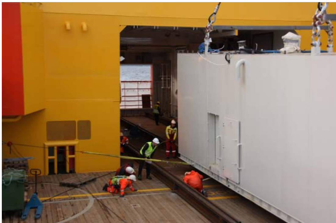
Εικόνα 3.15 Τοποθέτηση συστήματος κυψελών καυσίμου στο πλοίο Viking Lady [40].
