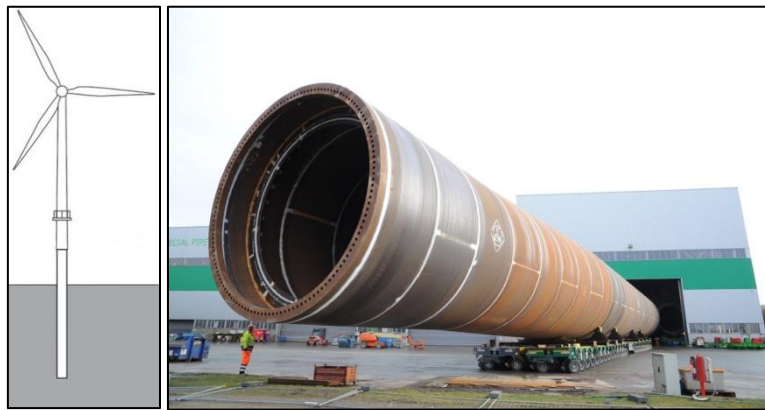
Εικόνα 4.4: Απεικόνιση τυπικής χερσαίας ανεμογεννήτριας με θεμελίωση μονοπάσσαλου
