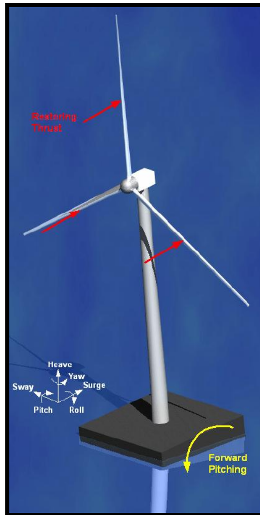
Εικόνα 4.4: Ορισμός στροφικών κινήσεων πλατφόρμας πλωτής ανεμογεννήτριας
