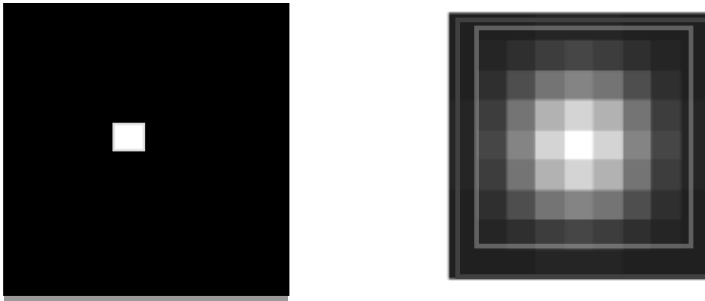
Εικόνα 6.1.1-Η Συνάρτηση Διασποράς Σημείου είναι η εικόνα του μοναδικού φωτεινού εικονοστοιχείου.
