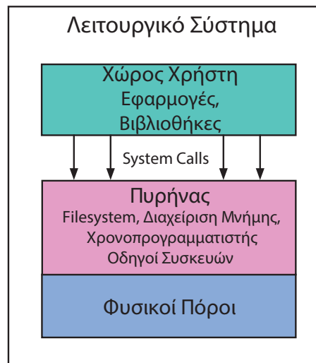
Σχήμα 5: Η βασική δομή ενός λειτουργικού συστήματος.
