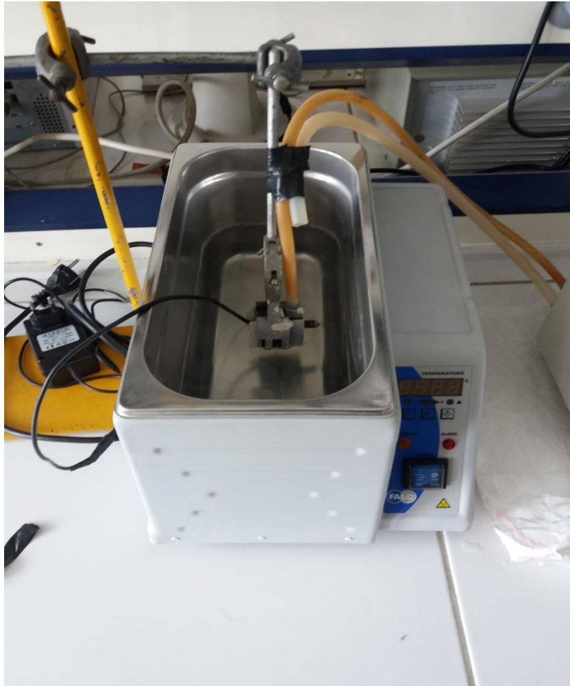
Εικόνα 3.2 Θερμοστατούμενο υδατόλουτρο που συνδέεται με τον ζυγό DuPont.
