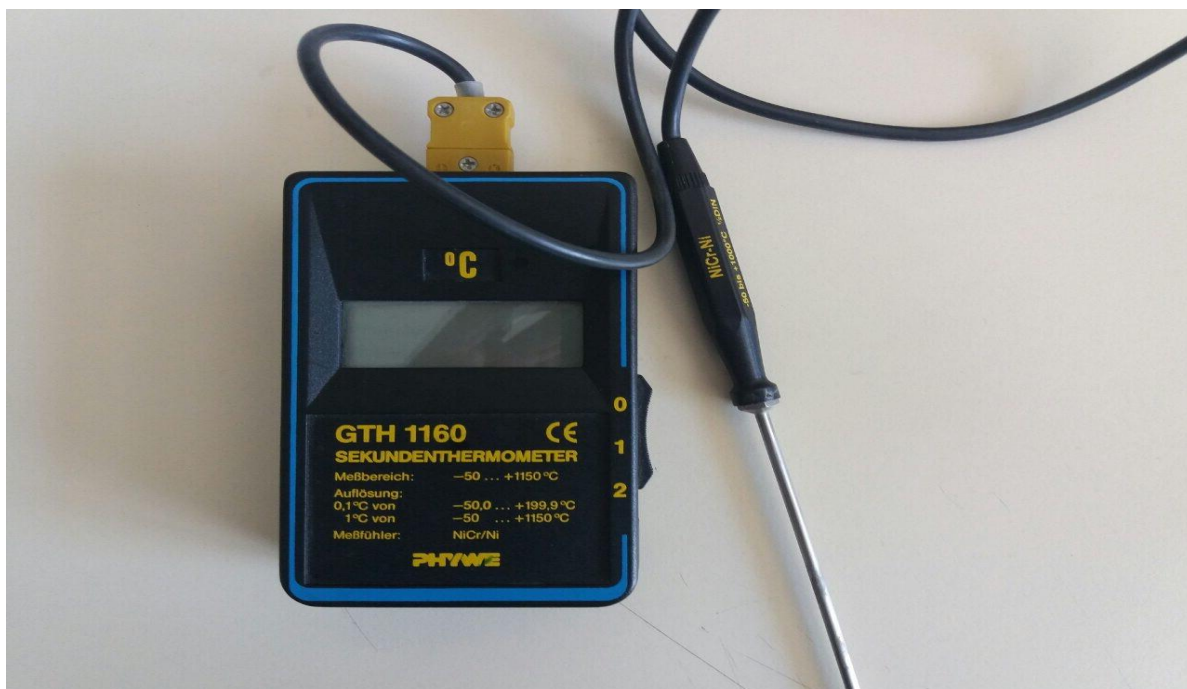
Εικόνα 3.3 Ηλεκτρονικό θερμομέτρο ελέγχου της θερμοκρασίας εντός του δειγματοφορέα.
