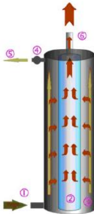
Σχήμα 17: Σχηματική αναπαράσταση της λειτουργίας της συσκευής αντίστροφης όσμωσης
